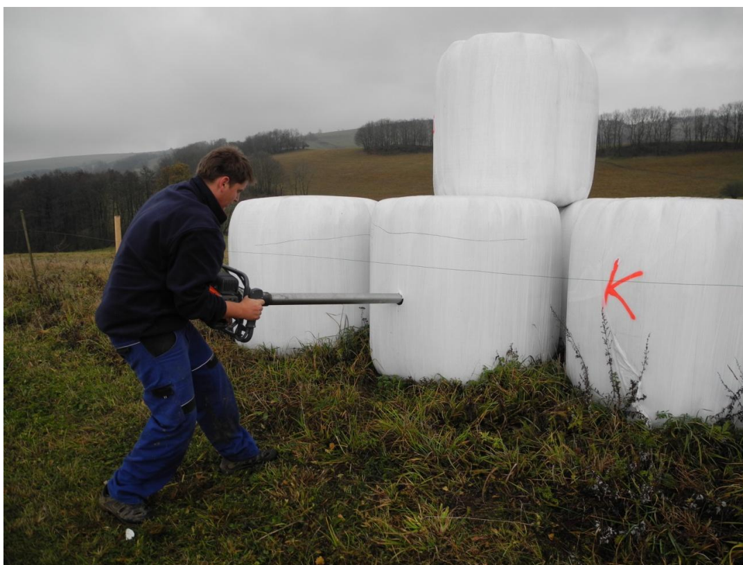
Fotografie 4: Odebírání vzorků pomocí tyčového vzorkovače
