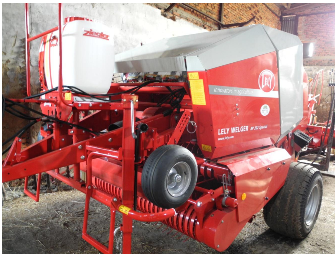
Fotografie 2: Svinovací lis s pevnou komorou s aplikátorem aditiv
