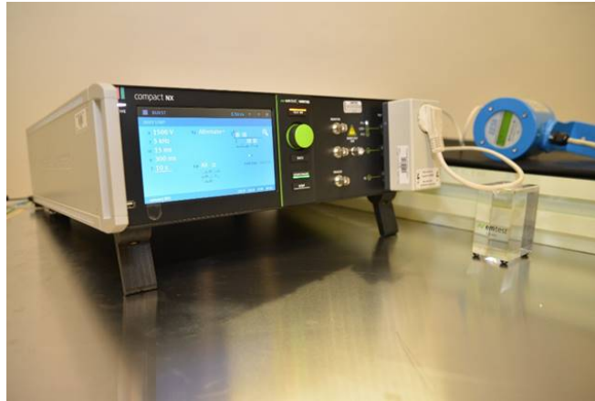
Obrázek 4.4: Testování odolnosti zařízení vůči EFT/B
