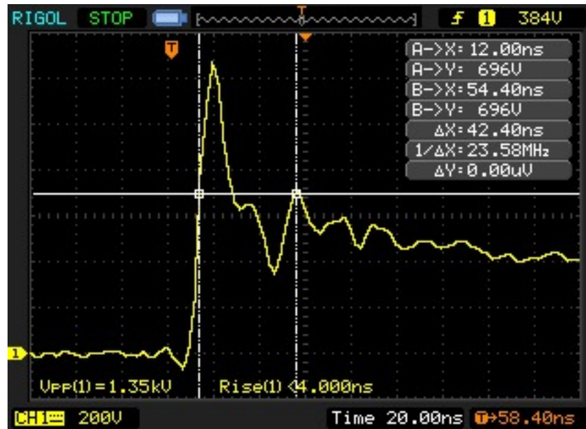
Obrázek 4.6: Změřený impuls EFT/B 1 kV
