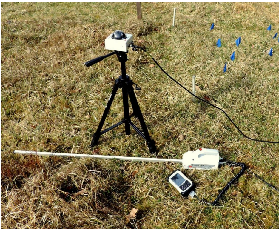
Příloha 3: Přístroj k měření množství světla procházejícího rostlinným pokryvem.
