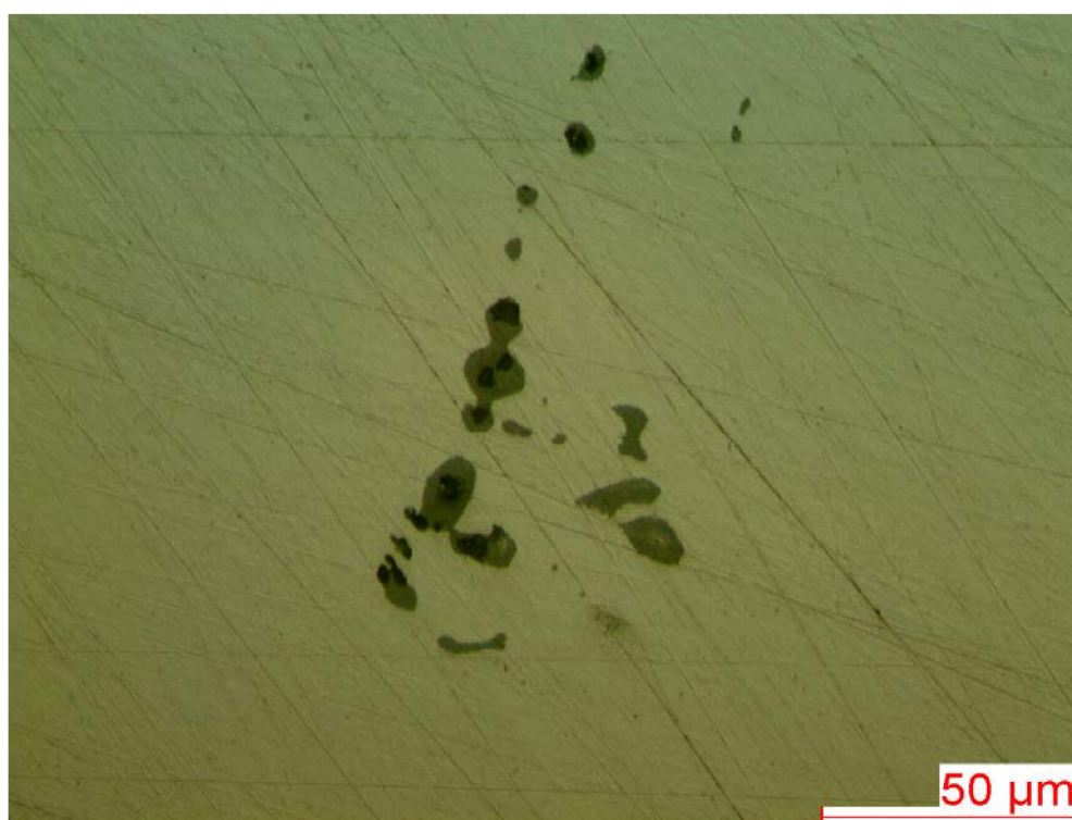
Obr. IV.2 Mikročistota litého materiálu – oxidicko-sulfidické vměšky
