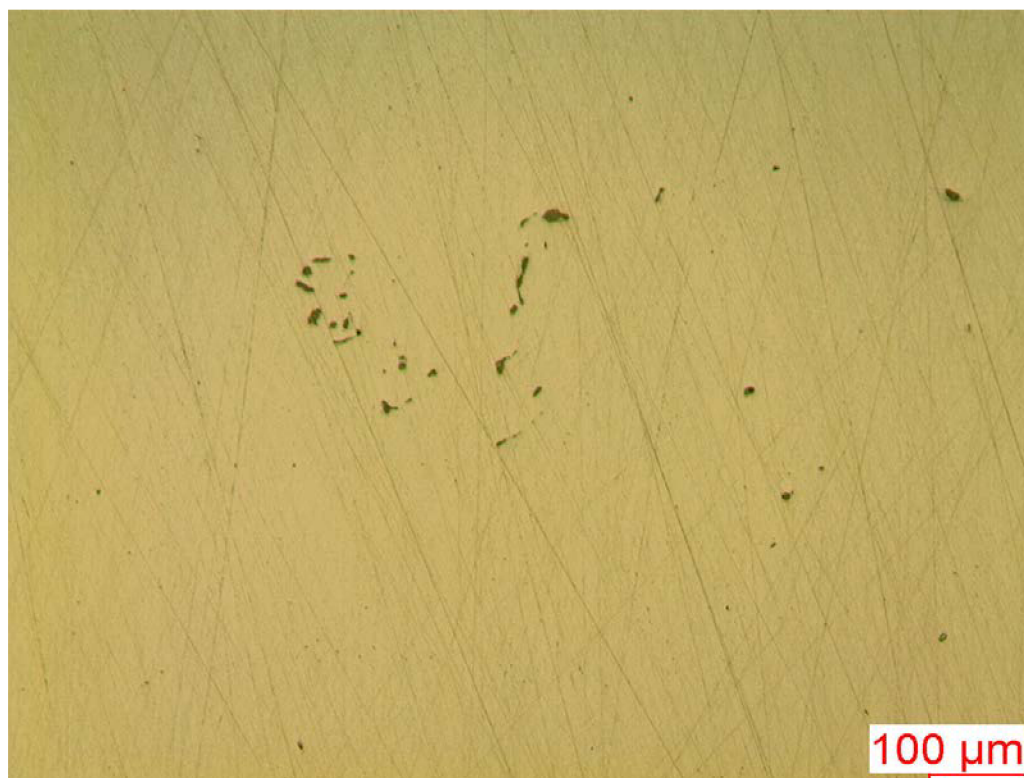
Obr. IV.5 Mikročistota tvářeného materiálu napříč směru tváření – sulfidické vměstky
