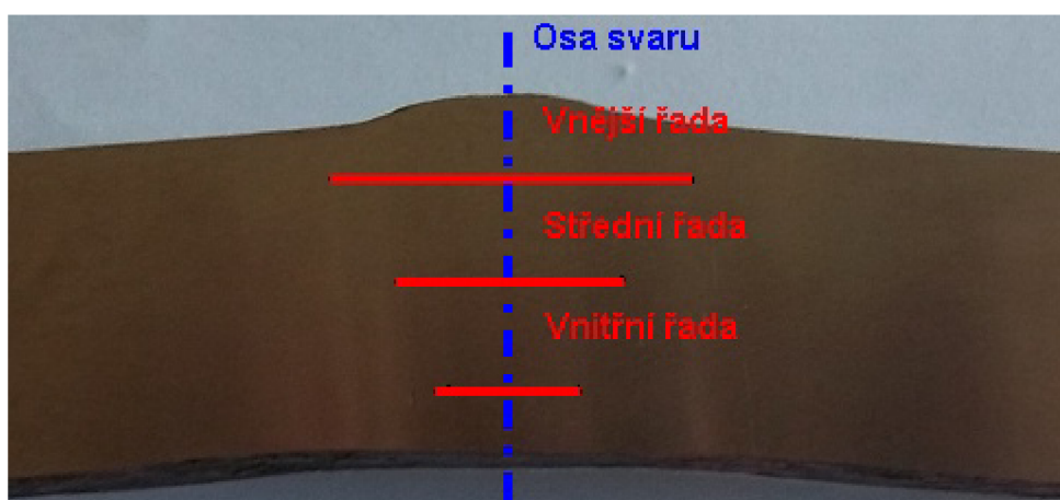
Obr. 16 Umístění řad vtisků ve svaru při měření mikrotvrdosti
