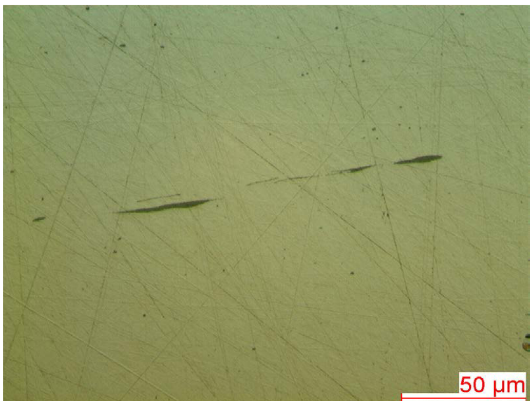
Obr. IV.4 Mikročisota tvářeného materiálu po směru tváření – sulfidické vměšky
