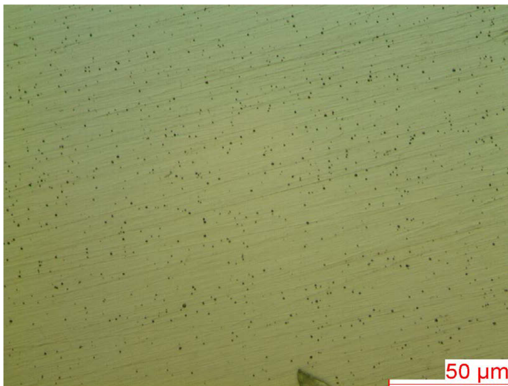
Obr. IV.6 Mikročistota svaru – bubliny po svařování
