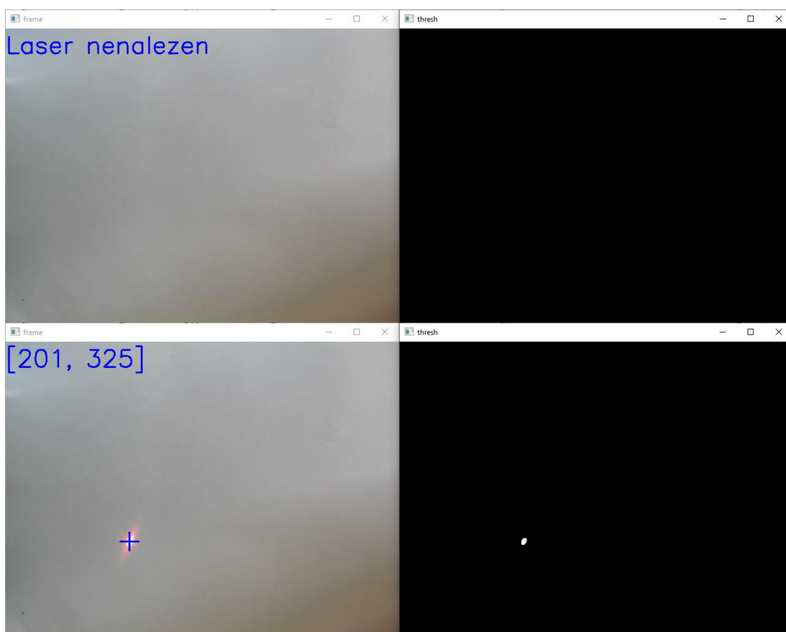
Obr. 10 Ukázka výstupu ze skriptu. Vlevo je výstup z kamery se zakresleným textem a křížkem. Vpravo je zpracovaný bitový obraz
