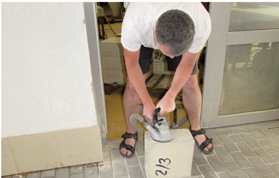
Obr. 31: Broušení betonových bloků pro tvrdoměrné zkoušení
