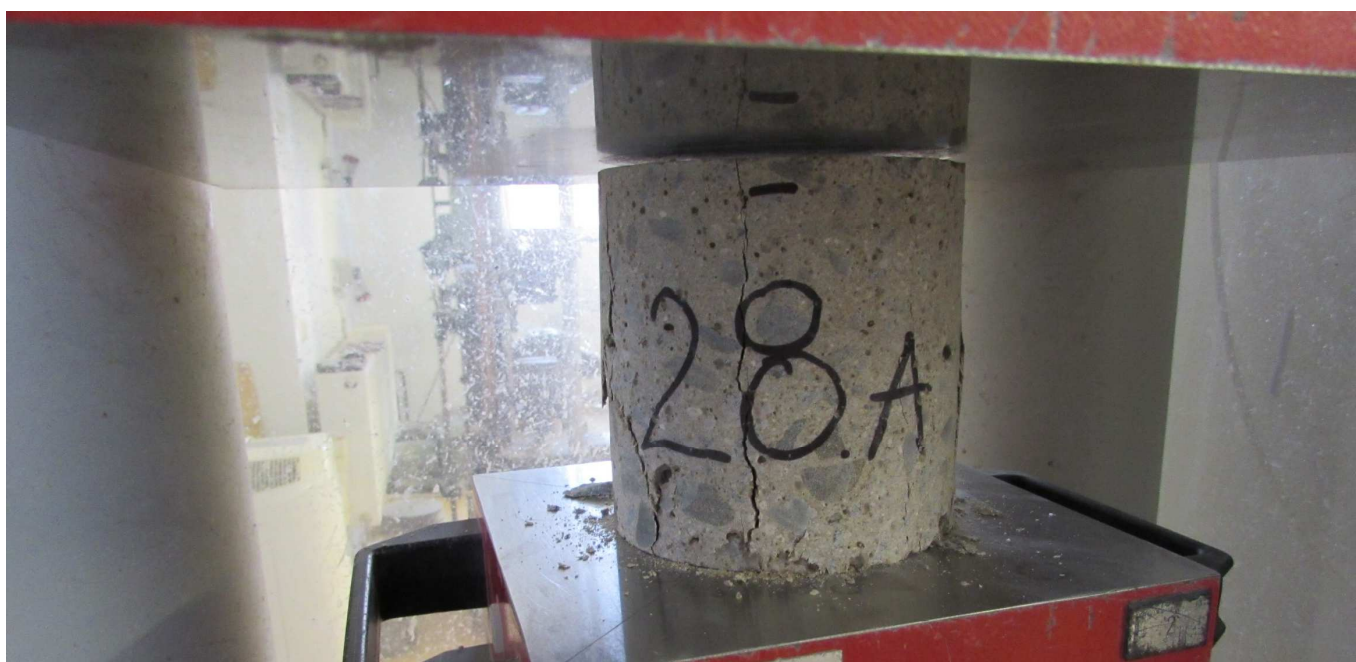
Obr. P17: Porušené zkušební těleso v lisu
