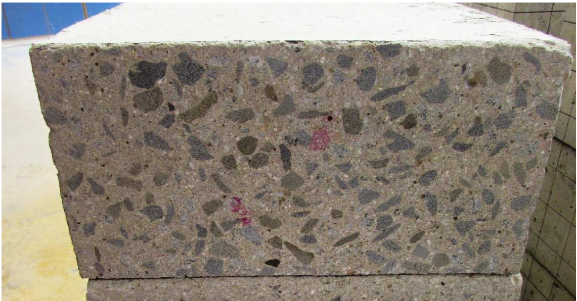
Obr. 5: Obroušená plocha pro tvrdoměrné zkoušení. Na dvě místa v ploše byl kápnut fenolftaleinový roztok – fialové zbarvení značí úspěšné odstranění zkarbonatované vrstvy
