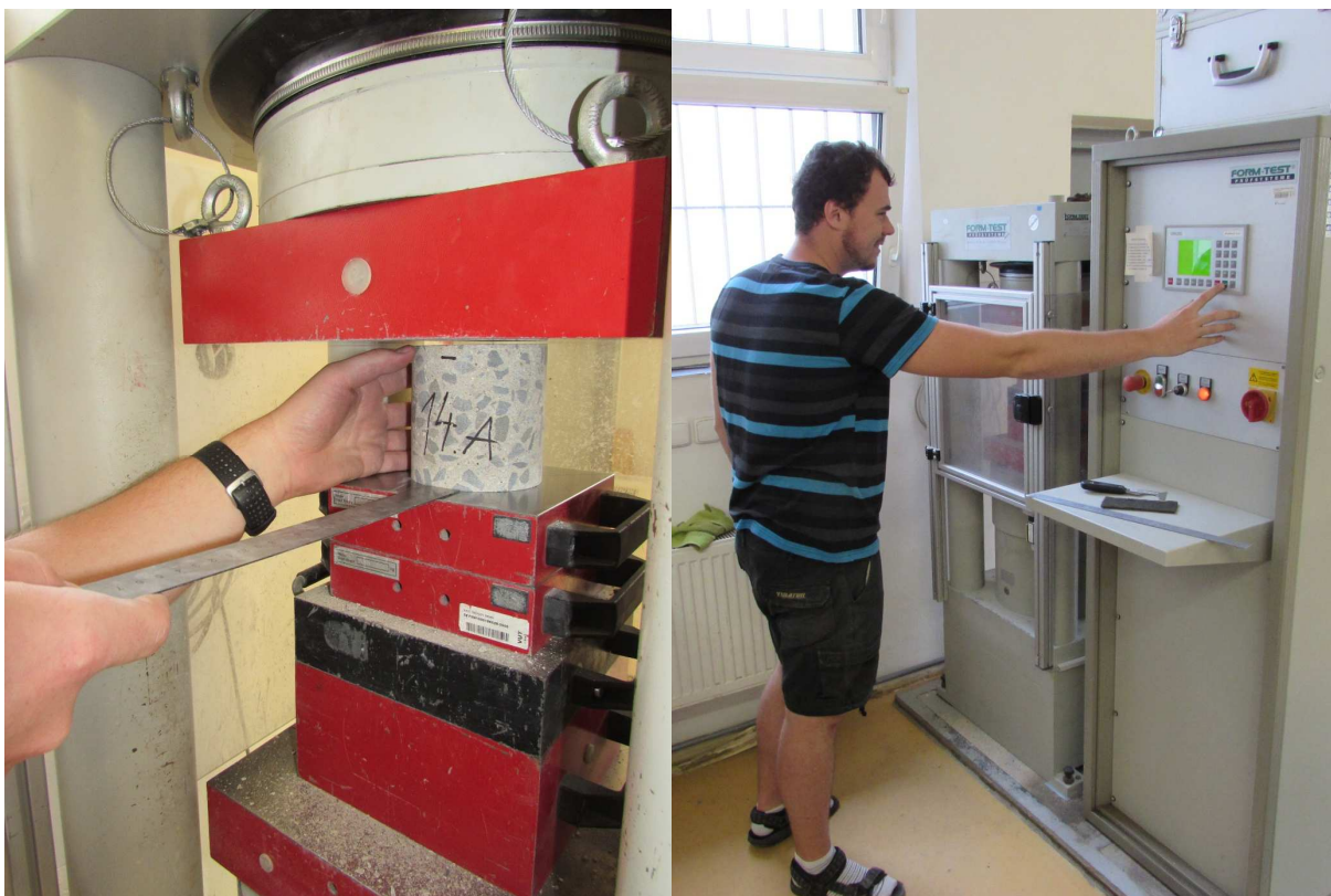
Obr. P16: Centrování tělesa v lisu (vlevo) a spuštění zatěžování (vpravo)
