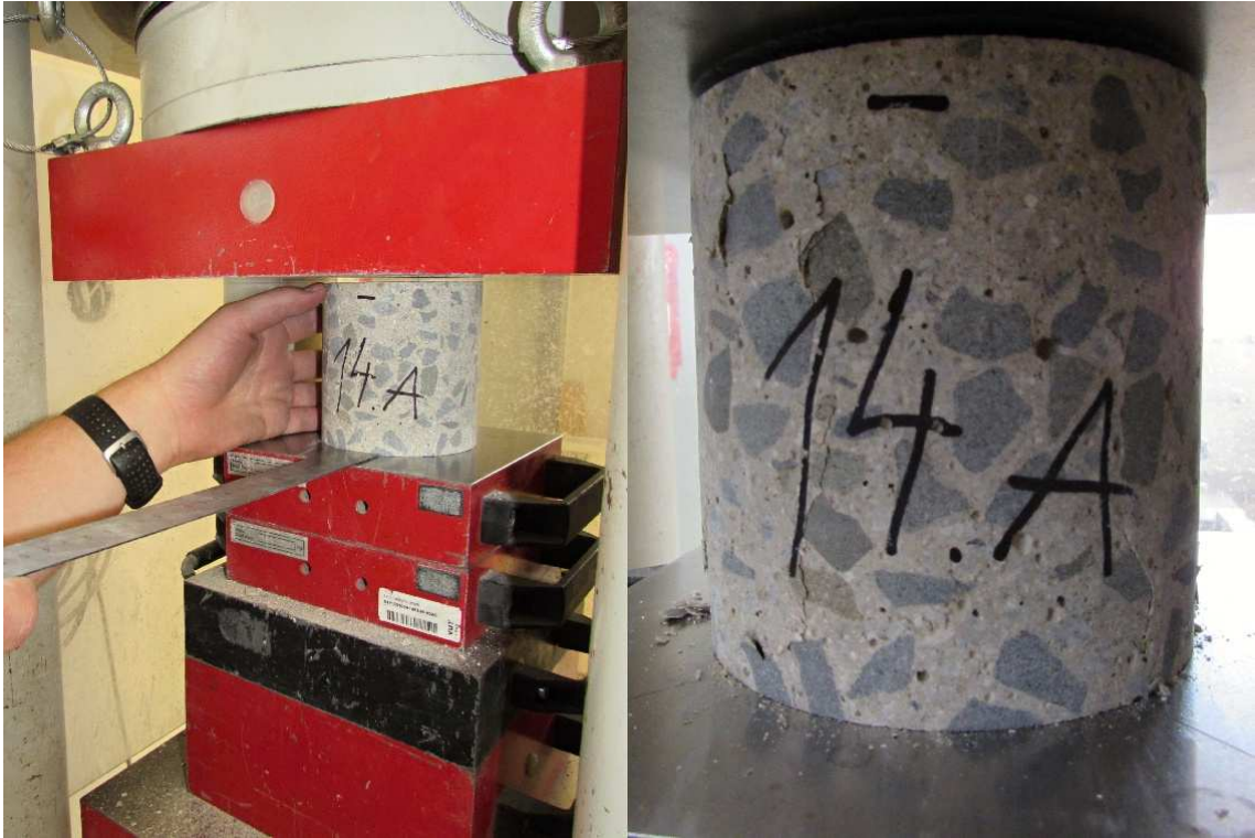
Obr. 14: Zkouška pevnosti v tlaku betonu – vlevo vkládání zkušebního tělesa do zkušebního lisu, vpravo detail porušení zkušebního tělesa
