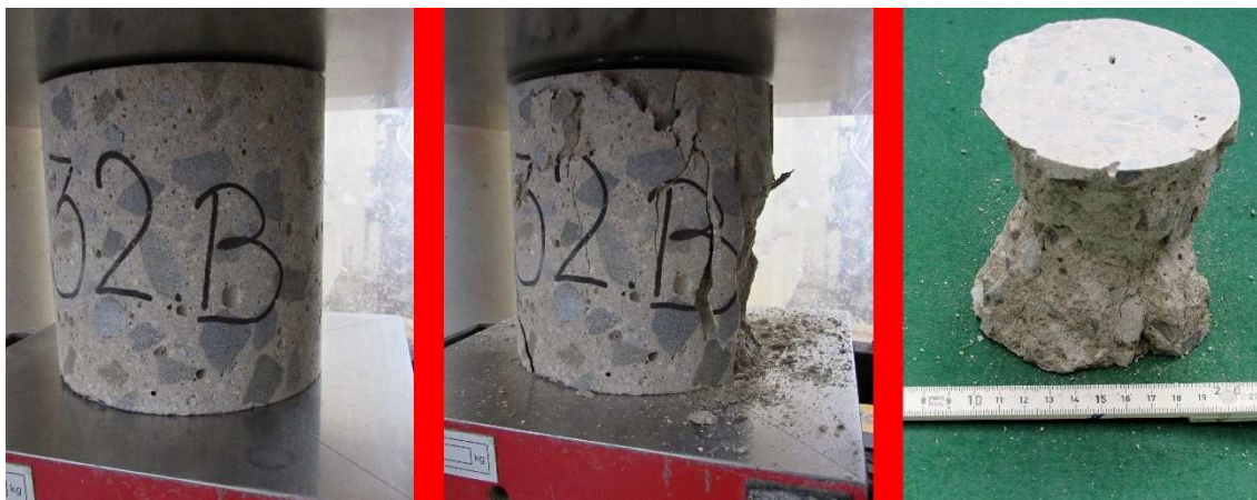
Obr. 39: Zkušební těleso 32.B (zleva): neporušené v lisu, porušené v lisu, odstranění volných částí – tvar „přesýpacích hodin“
