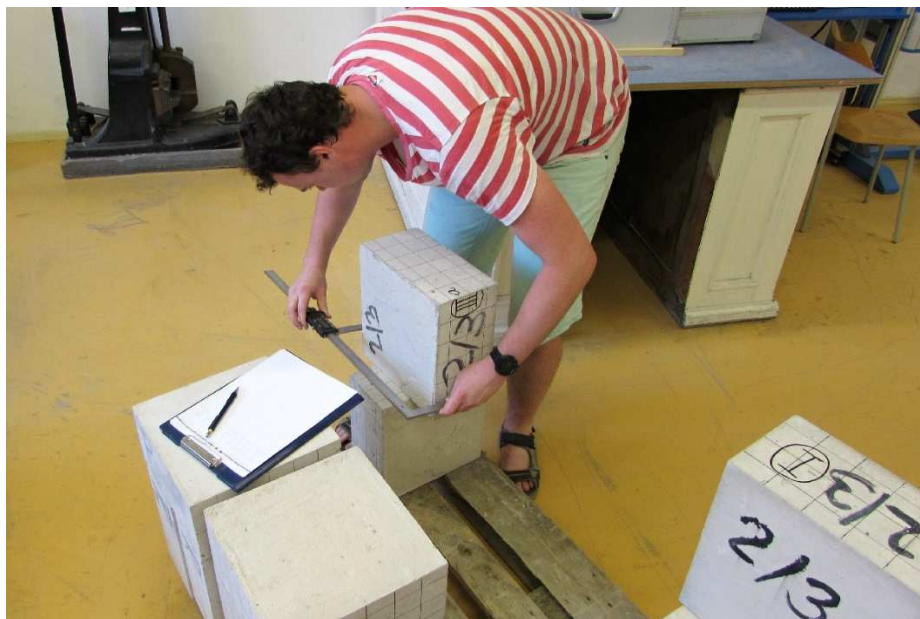
Obr. 25: Měření rozměrů bloků posuvným měřítkem pro zkoušení ultrazvukem
