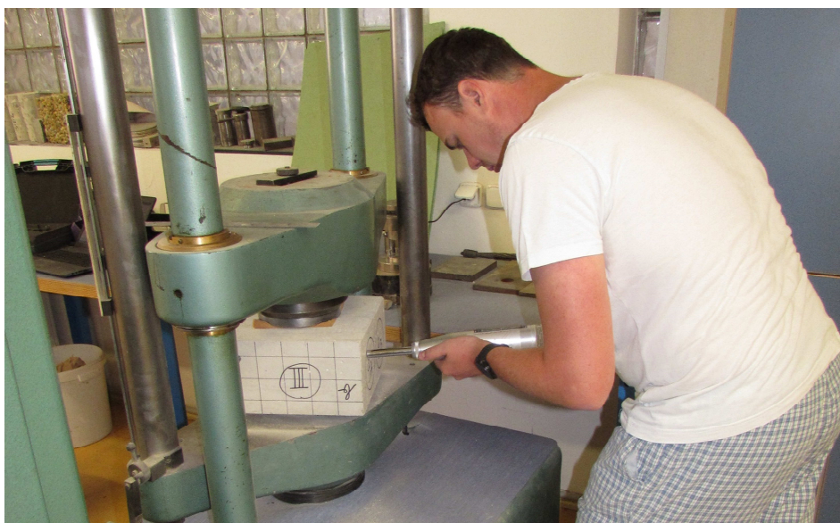
Obr. P9: Tvrdoměrné zkoušení odrazovým tvrdoměrem Original Schmidt N
