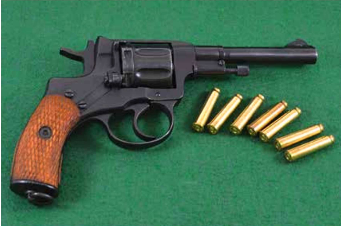
Obr. 1: Revolver systému Nagant pro zkoušení betonu [3]
