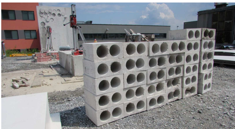
Obr. P12: Všech 32 betonových bloků po odběru jádrových vývrtnů
