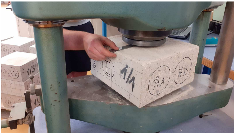
Obr. P7: Řádné centrování bloku ve zkušebním lisu
