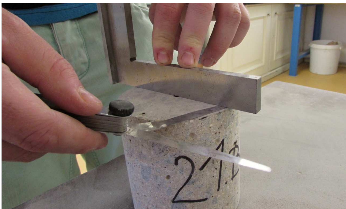
Obr. 38: Zjišťování rovinnosti pomocí ocelových spárových měrek
