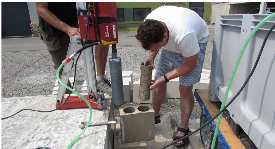
Obr. P11: Odběr jádrového vývrtnu
