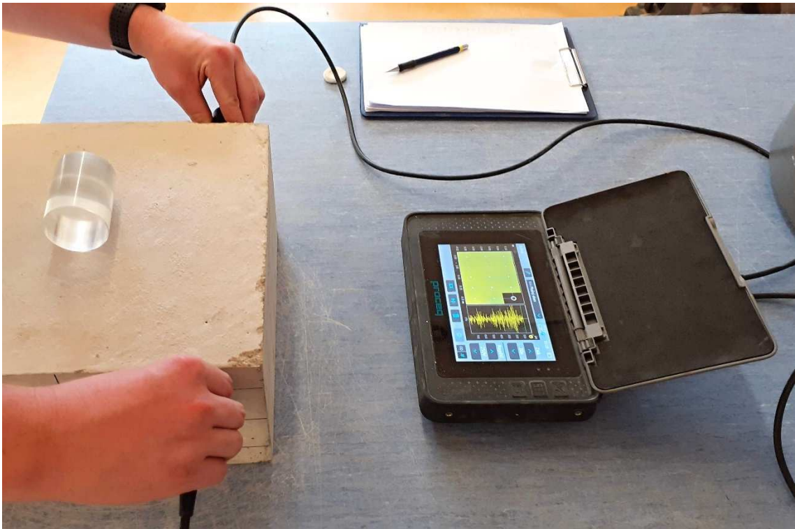
Obr. 8: Práce s přístrojem Pundit PL-200 od firmy Proceq SA
