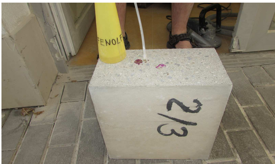
Obr. P5: Aplikace fenolftaleinového roztoku na čerstvě obroušené a oprášené plochy
