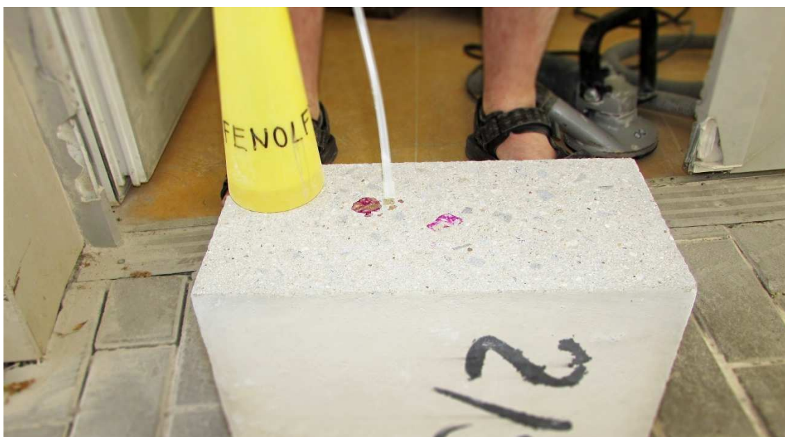
Obr. 32: Aplikace roztoku fenolftaleinu na obroušenou stranu betonového bloku
