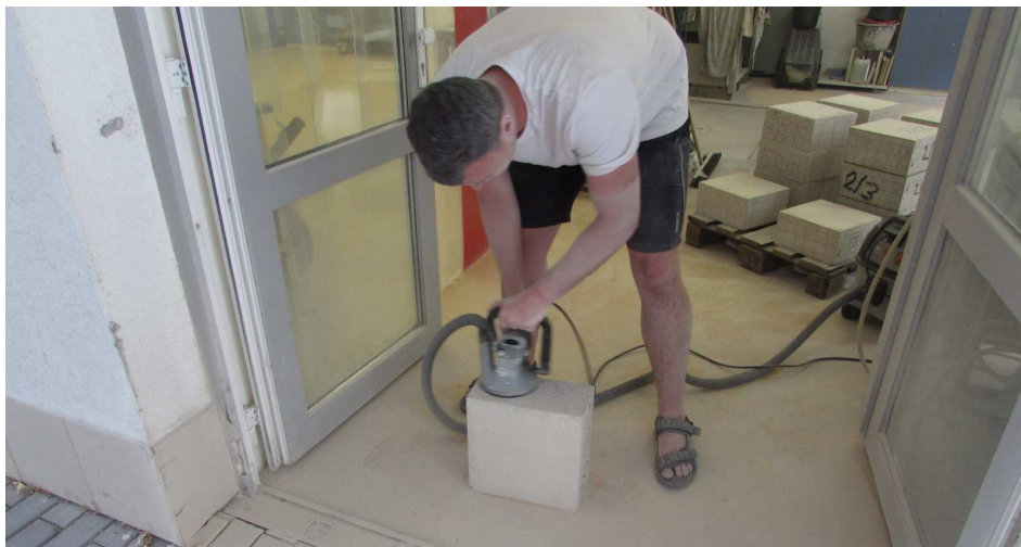
Obr. P4: Obroušení zkarbonatované vrstvy betonových bloků na místech budoucího tvrdoměrného zkoušení
