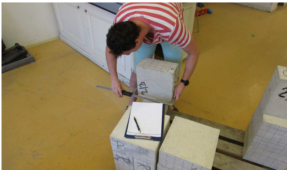
Obr. P2: Měření rozměrů betonových bloků
