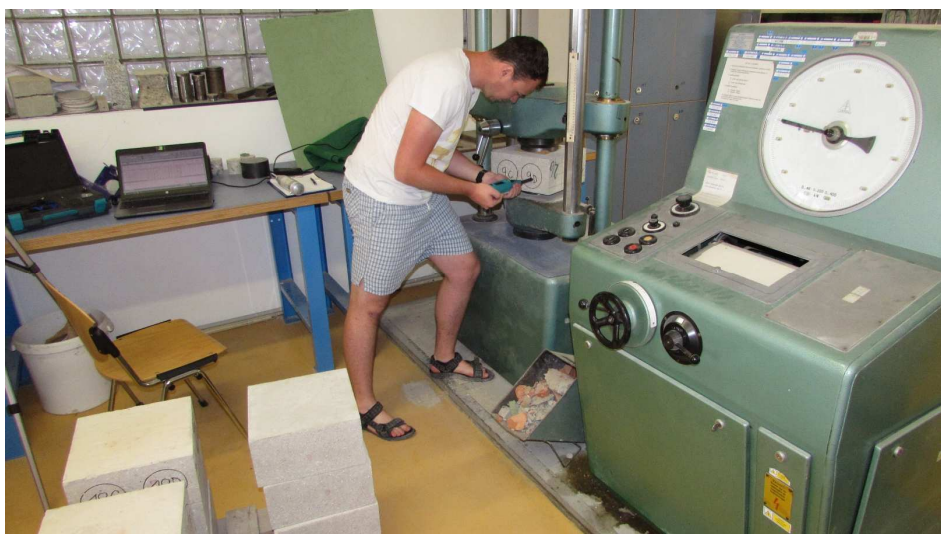
Obr. P8: Tvrdoměrné zkoušení odrazovým tvrdoměrem SilverSchmidt N
