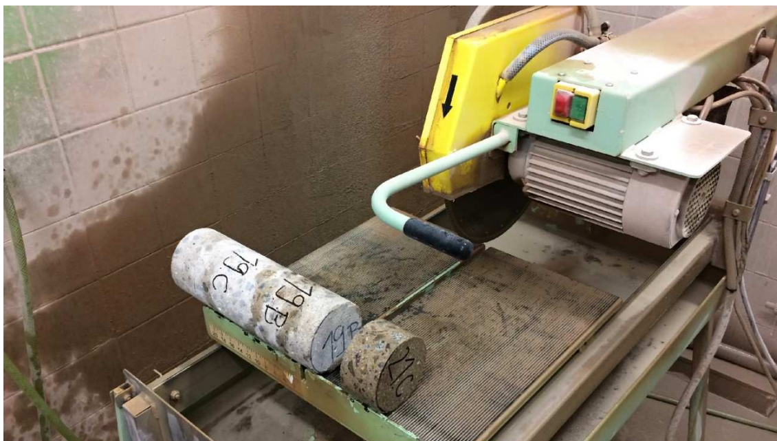
Obr. 37: Jádrové vývrty byly rozřezány na okružní pile
