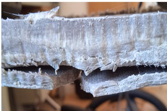
Obrázek 185: Delaminace v důsledku ohybového zatížení
