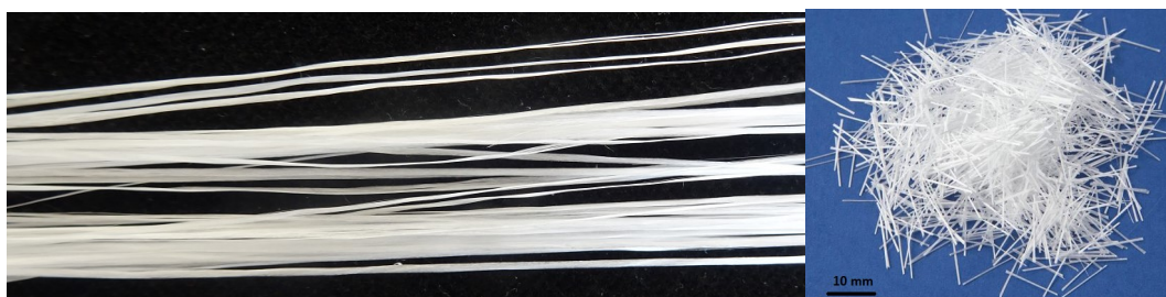
Obrázek 61: AR-skleněný roving; Antikorozní skleněná vlákna Cem-FIL [23]
