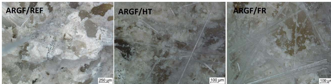
Obrázek 130: Digitální mikroskop; geopolymerní matrice s AR-skleněnými vlákny; porovnání referenčního vzorku se vzorkem po teplotním šoku a zkoušce mrazuvzdornosti
