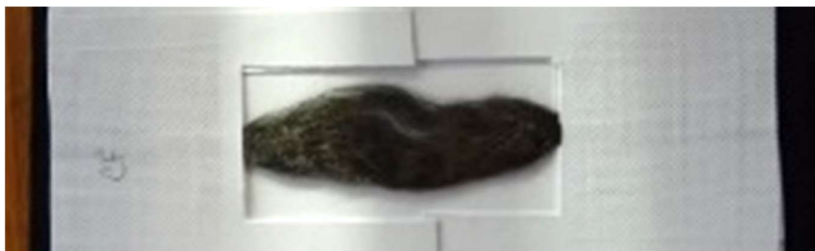
Obrázek 69: Vzorky uhlíkových vláken po tahové zkoušce, kontrolní skupina
