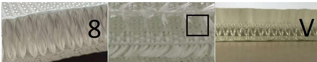
Obrázek 51: Různé uspořádání pilotů v distanční tkanině, přidané symboly označují tvar uspořádání [118]
