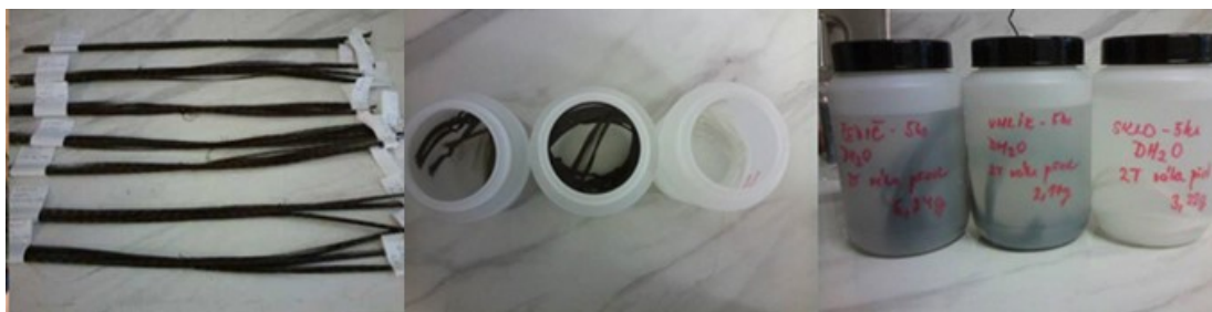
Obrázek 75: Příprava experimentu a průběh experimentu stanovení chemické odolnosti vláknových rovingů
