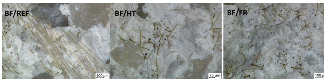
Obrázek 129: Digitální mikroskop; geopolymerní matrice s čedičovými vlákny; porovnání referenčního vzorku se vzorkem po teplotním šoku a zkoušce mrazuvzdornosti
