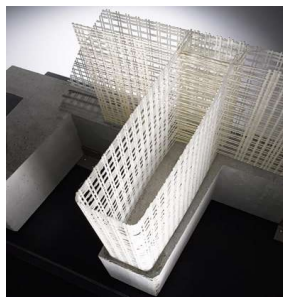
Obrázek 55: Fasádní prvky – 3D výztuž z ARGF [131]
