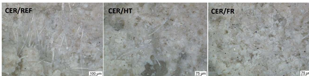
Obrázek 132: Digitální mikroskop; geopolymerní matrice s vlákny z keramické ucpávky; porovnání referenčního vzorku se vzorkem po teplotním šoku a zkoušce mrazuvzdornosti
