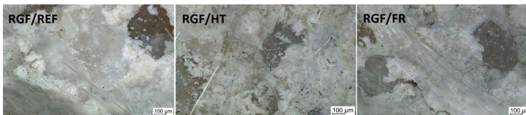
Obrázek 131: Digitální mikroskop; geopolymerní matrice s R-skleněnými vlákny; porovnání referenčního vzorku se vzorkem po teplotním šoku a zkoušce mrazuvzdornosti
