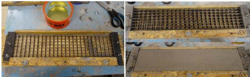
Obrázek 182: Příprava kompozitních vzorků vyztužených čedičovou geosítí
