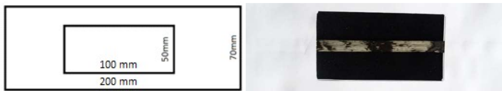
Obrázek 68: Rozměry papírového rámečku a vzorek pro tahovou zkoušku
