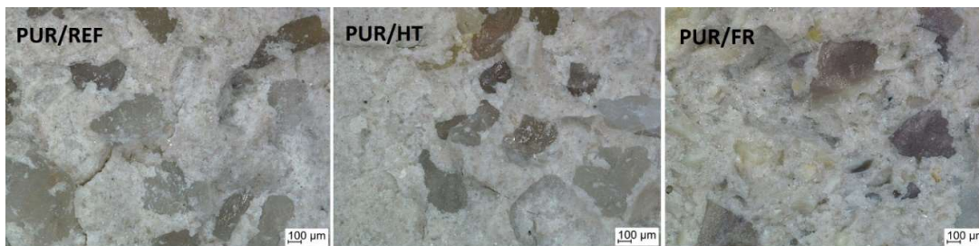
Obrázek 127: Digitální mikroskop; geopolymerní matrice bez výztuže; porovnání referenčního vzorku se vzorkem po teplotním šoku a zkoušce mrazuvzdornosti
