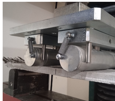
Obrázek 73: Zkouška čtyřbodovým ohybem
