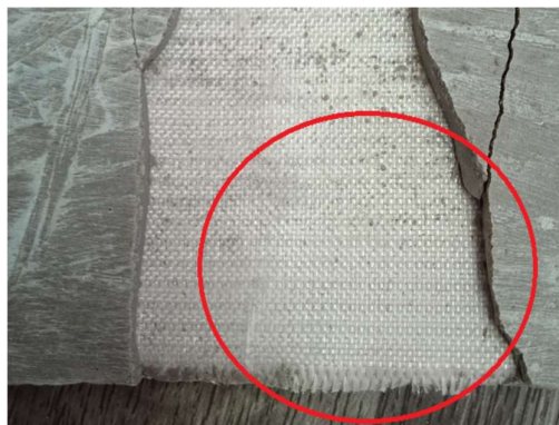
Obrázek 186: Testovaný vzorek geopolymerní matrice s WoSF 5 mm
