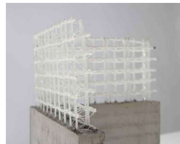
Obrázek 56: Stavební prvky; AR-mřížky napuštěné pryskyřicí [131]
