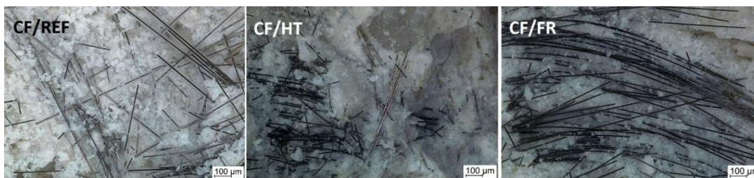
Obrázek 128: Digitální mikroskop; geopolymerní matrice s uhlíkovými vlákny; porovnání referenčního vzorku se vzorkem po teplotním šoku a zkoušce mrazuvzdornosti
