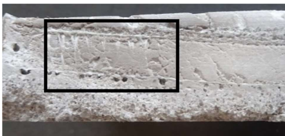
Obrázek 176: Skleněná distanční tkanina v geopolymerním kompozitu
