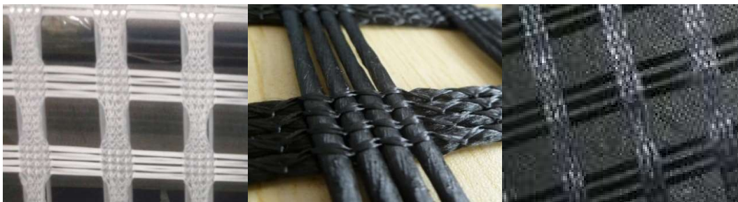
Obrázek 43: Příklady geomříží ze skleněných a uhlíkových vláken [110], s přidanou netkanou textilií [109]
