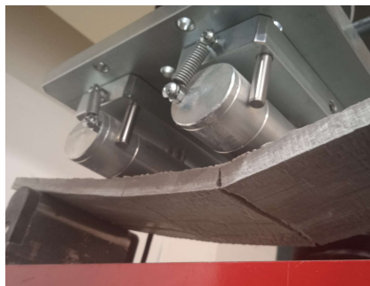
Obrázek 183: Uspořádání zkoušky; testování WoSF, čtyřbodový ohyb
