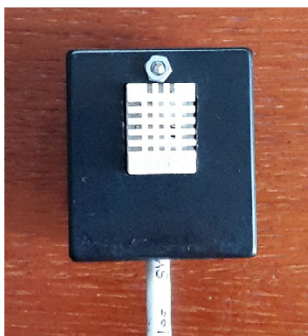
Obrázek 26: Senzor DHT22 zabudovaný v krabičce
