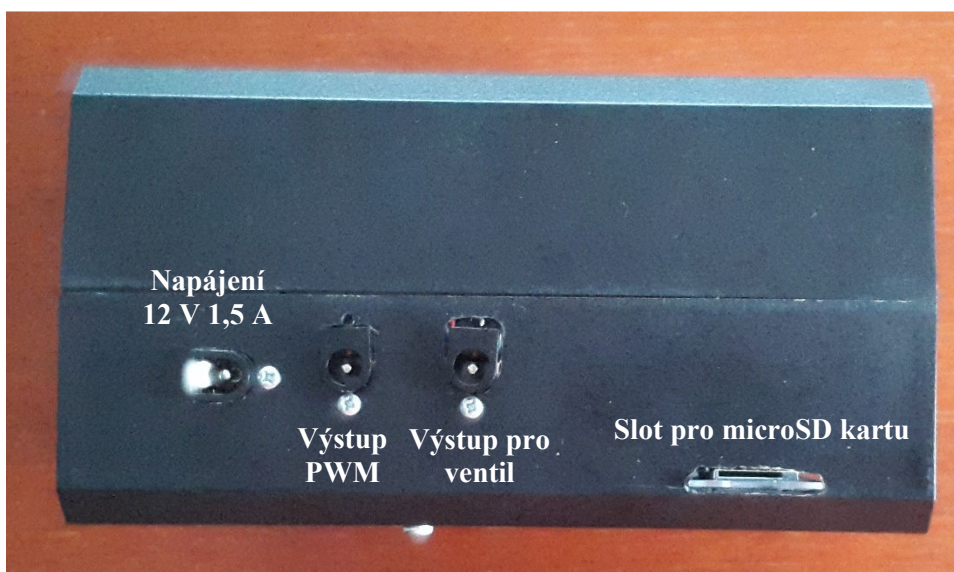
Obrázek 28: Bok krabičky osazený sousými konektory a slotem pro microSD kartu
