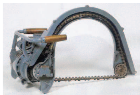
Obr. 7: První elektrická jednomužná pila Dolmar typ DB 35 (Dolmar, 2007)
