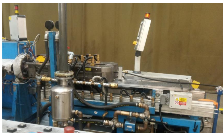
Obr. 23) Kalibrační zařízení (korugátor) a vytlačená trubka [18]
