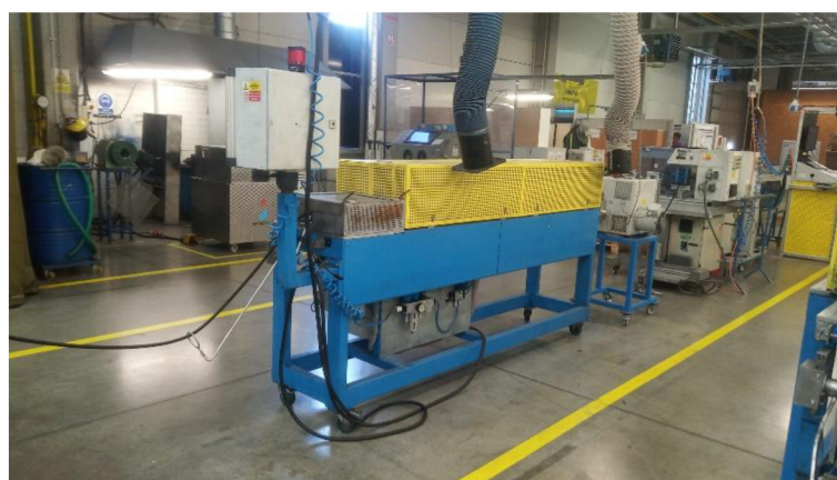
Obr. 24) Řezací stroj pro podélné řezání trubky [18]
