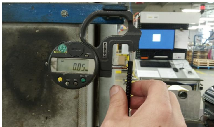
Obr. 30) Ukázka kontrolní zkoušky - centricita [18]
