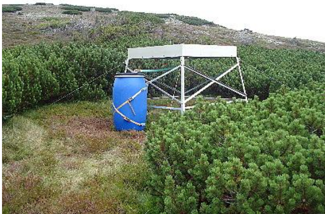
Foto 13 Zařízení na jímání dešťové vody v Krkonoších.
