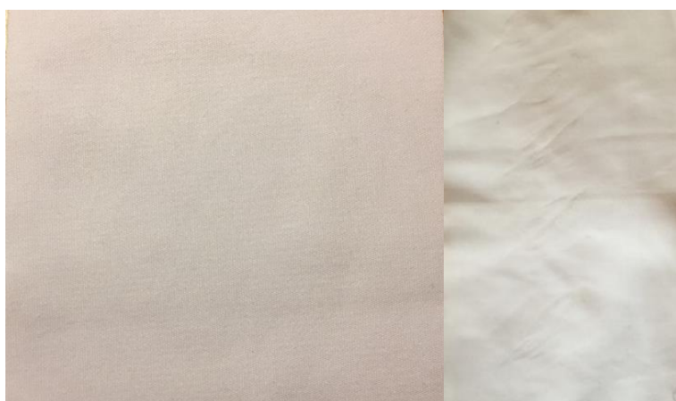
Obrázek 49. - Porovnání vzorků Gelanots HB 3L hardshell před a po cyklické mačkavosti
