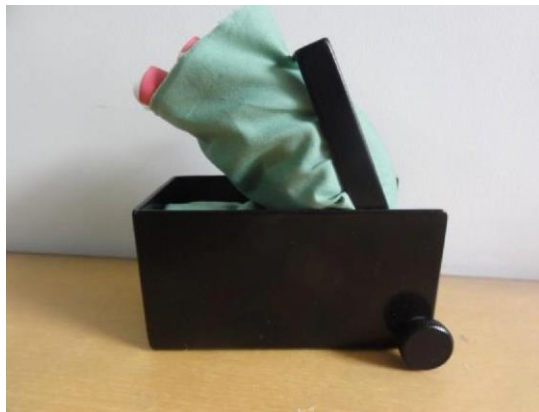
Obrázek 9. - přístroj na simulaci lidského kloubu [1]
