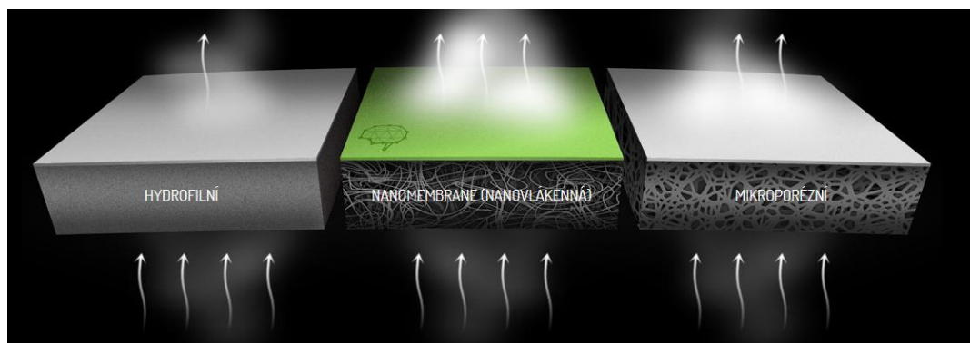
Obrázek 6. - Srovnává propustnost vodních par i membrán. [14]
