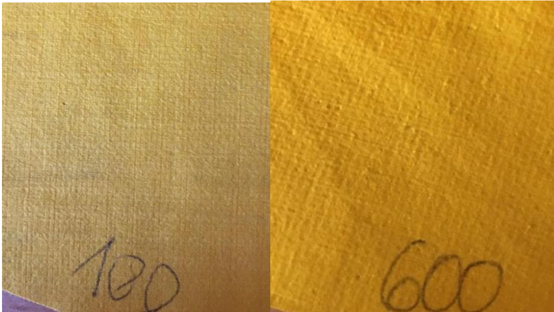
Obrázek 32. - porovnání po uplynutí 100 a 600 otáček na materiálu Gelanots HB 3L hardshell
