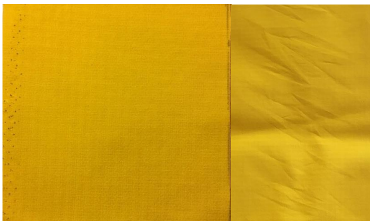
Obrázek 49. - Porovnání vzorků Gelanots HB 3L hardshell před a po cyklické mačkavosti
