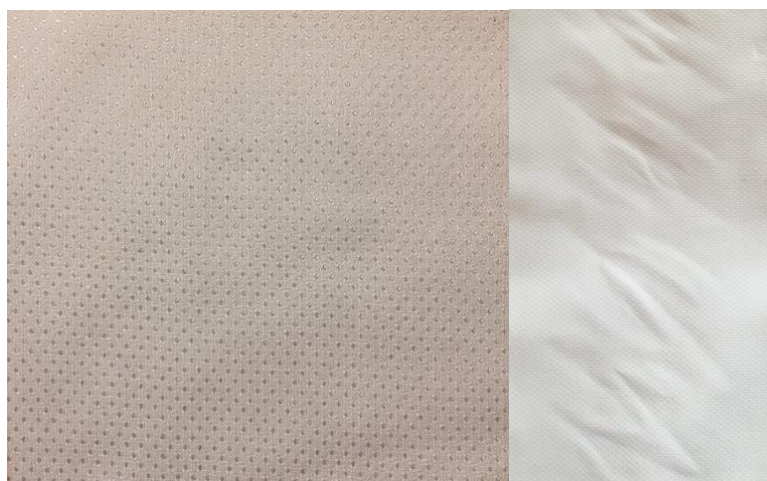
Obrázek 51. - Porovnání vzorků Zerowind thermo před a po cyklické mačkavosti
