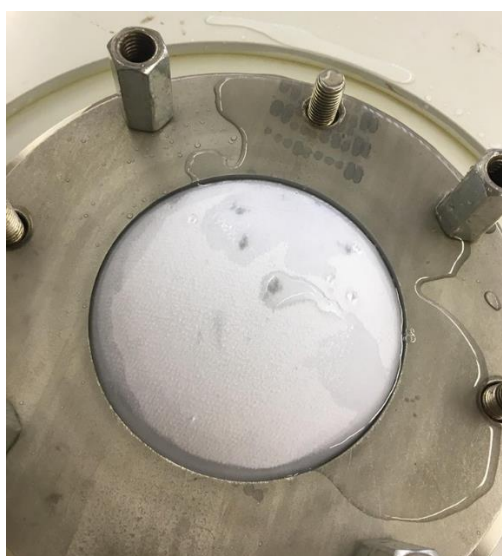
Obrázek 40. - Pronikání prvních kapek vody u materiálu Zerowind fine
