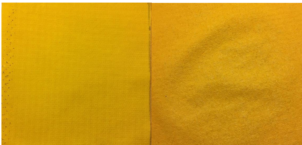
Obrázek 37. - Porovnání vzorků Gelanots HB 3L hardshell před a po oděru
