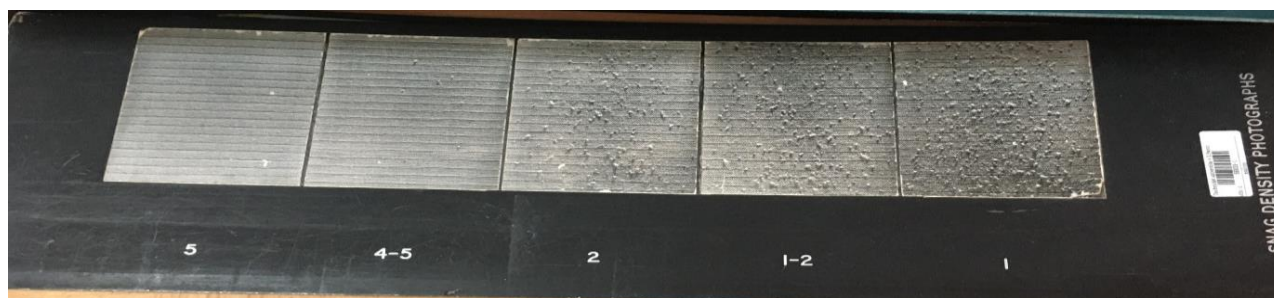
Obrázek 31. - Stupnice etalonů Mace snag tester
