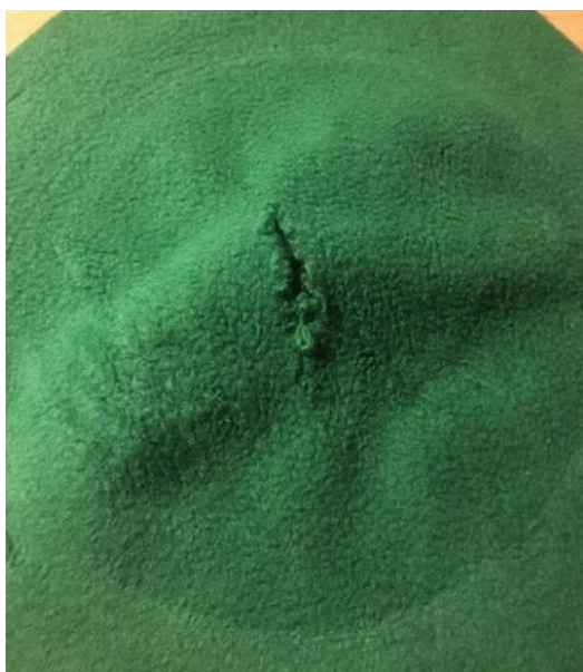
Obrázek 52. - Protržení Softshellu z rubní strany
