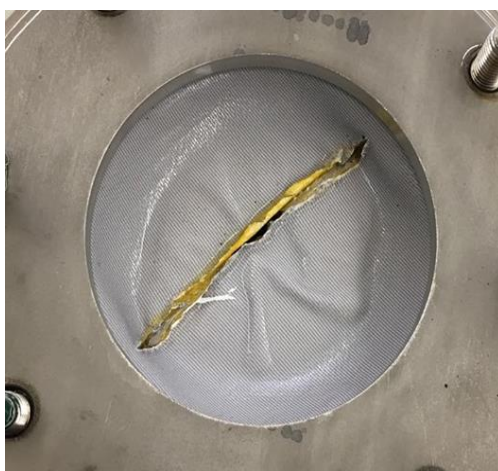
Obrázek 26.- protržení vzorku během testování (Gelanots HB 3L hardshell)
