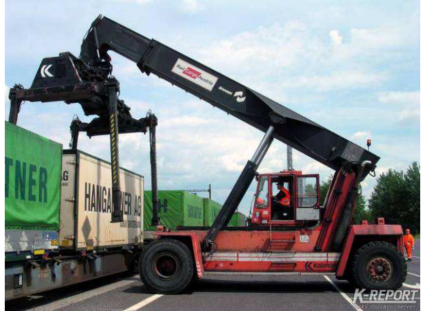
Obr. 10 Kalmar (výsuvný stohovač) - spreder s kleštinami {9}
