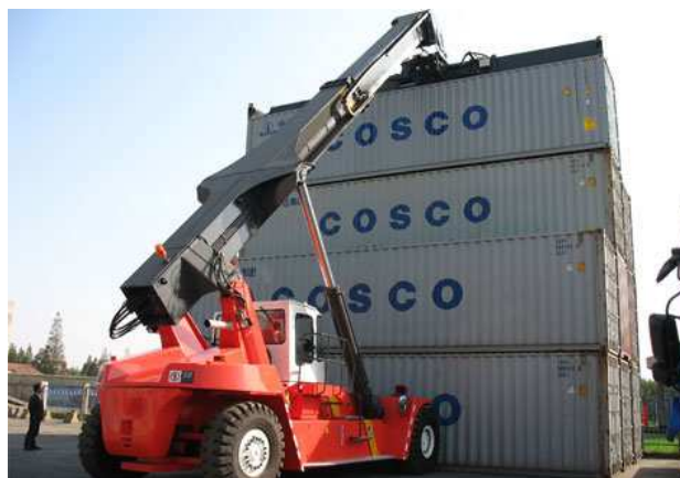
Obr.11 Výsuvný stohovač s vrchním spreaderem {10}
