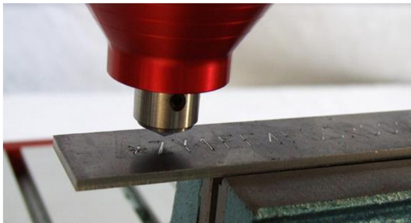
Obr. 4 - Ukázka značení rytím [6]
