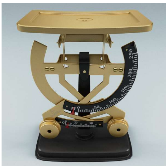
Obr. 2-13 Příklad kyvadlové váhy [29]
