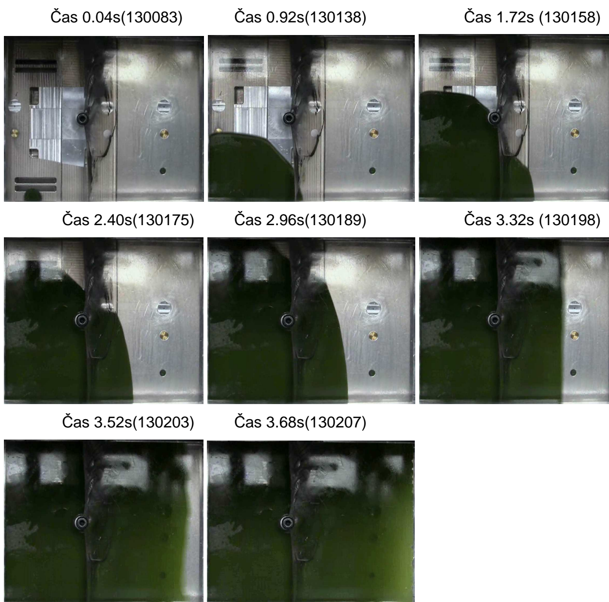
Obr. P2.12 Průběh zaplňování dutiny testovací formy II ve zvolených časových okamžicích při nastavení 2IIB32a. Nastavení vstřikovacích parametrů: Flow 250dílků a Pressure 320dílků. Čísla v závorce mají informativní účel a udávají číslo framu ze záznamu.
