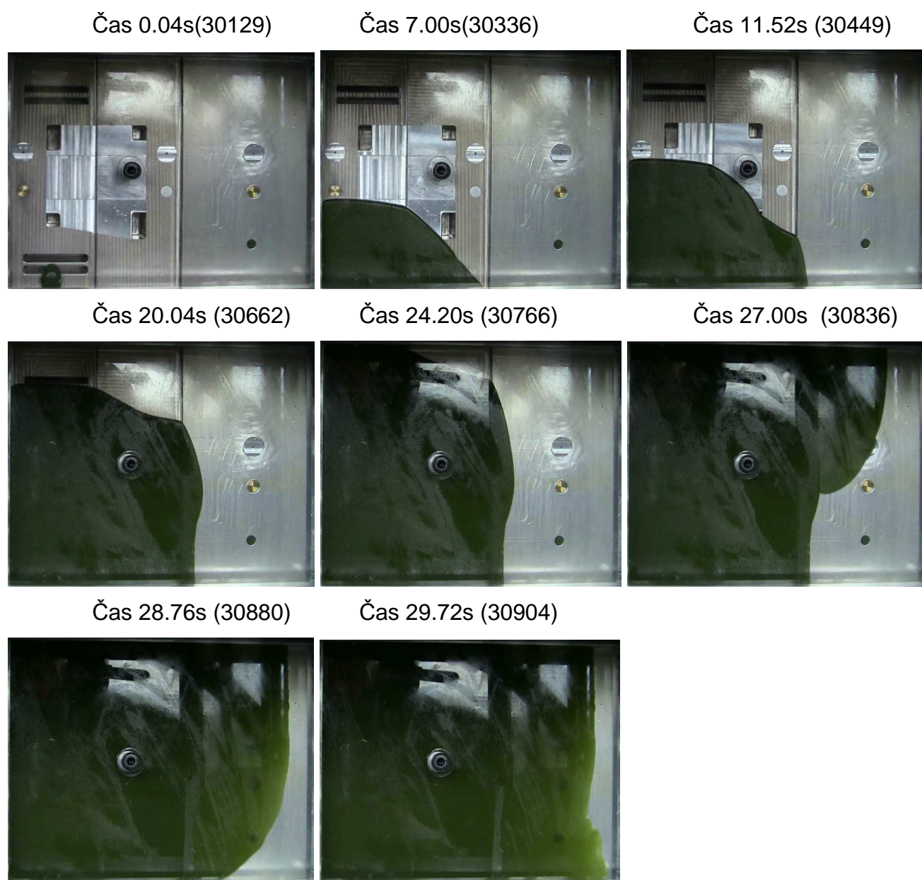
Obr. P2.4 Průběh zaplňování dutiny testovací formy II ve zvolených časových okamžicích při nastavení 2IIA30d. Nastavení vstřikovacích parametrů: Flow 150dílků a Pressure 300dílků. Čísla v závorce mají informativní účel a udávají číslo framu ze záznamu.
