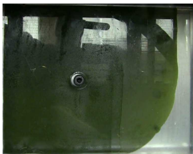
Obr. 2.3 Průběh zaplňování dutiny testovací formy II ve zvolených časových okamžicích při nastavení 2IIA30b. Čísla v závorce mají informativní účel a udávají číslo framu ze záznamu.
