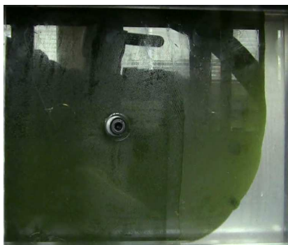
Obr. P2.2 Průběh zaplňování dutiny testovací formy II ve zvolených časových okamžicích při nastavení 2IIA30b. Nastavení vstřikovacích parametrů: Flow 150dílků a Pressure 300dílků. Čísla v závorce mají informativní účel a udávají číslo framu ze záznamu.
