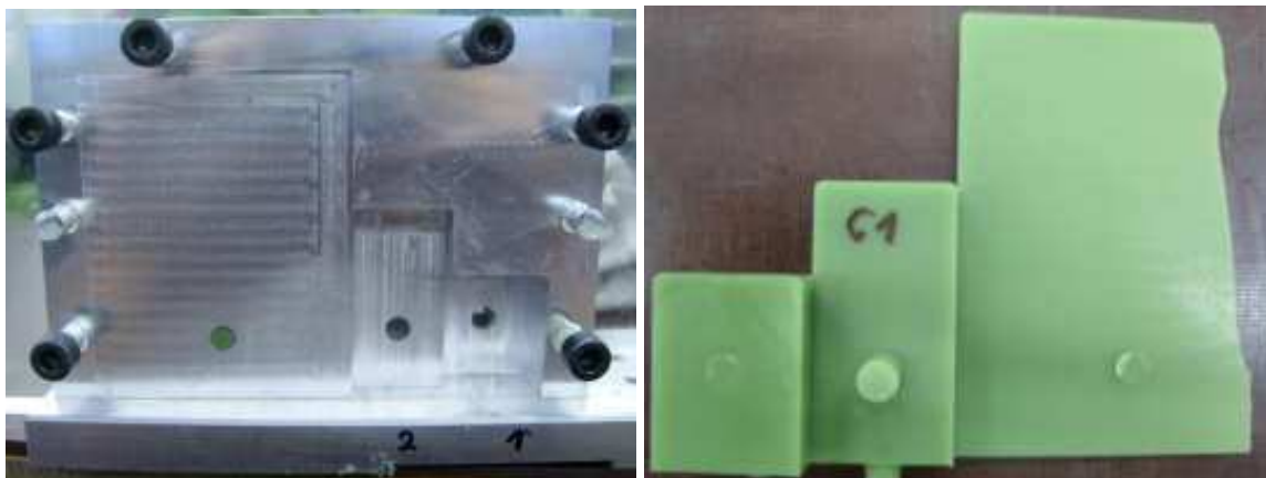
Obr. 1.9 Vlevo pohled na testovací formu I. Vpravo model vyrobený pomocí testovací formy I [19]
