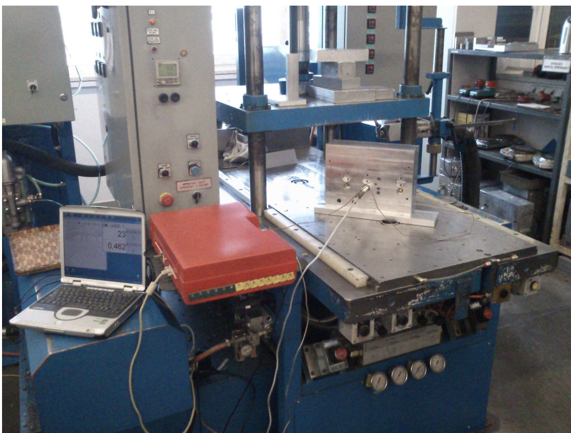
Obr. 2.1 Uspořádání experimentu měření tlaku a teploty na testovací formě II.
