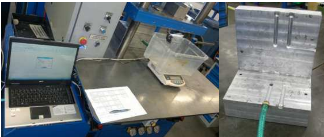
Obr. 2.6 Uspořádání experimentu měření „FLOW“. Vpravo – otevřená průtočná forma s pryžovým výstupem do měřící nádoby [19]
