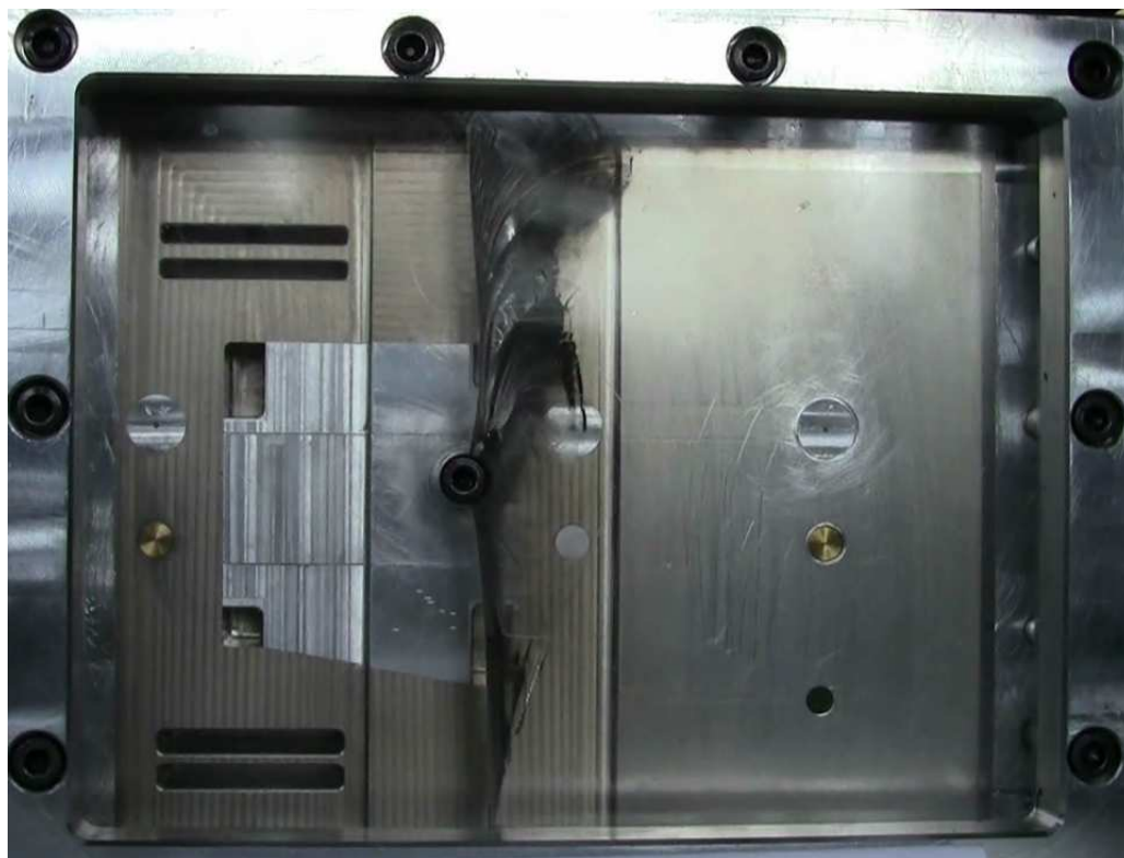
Obr. 2.2 Detail prasklého plexiskla
