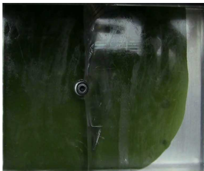
Obr. P2.7 Průběh zaplňování dutiny testovací formy II ve zvolených časových okamžicích při nastavení 2IIA15b. Nastavení vstřikovacích parametrů: Flow 150dílků a Pressure 150dílků. Čísla v závorce mají informativní účel a udávají číslo framu ze záznamu.
