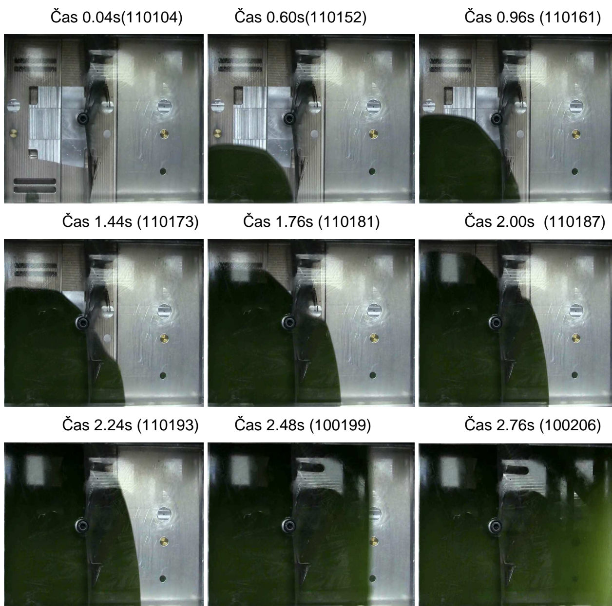
Obr. P2.11 Průběh zaplňování dutiny testovací formy II ve zvolených časových okamžicích při nastavení 2IIC15b. Nastavení vstřikovacích parametrů: Flow 300dílků a Pressure 150dílků. Čísla v závorce mají informativní účel a udávají číslo framu ze záznamu.
