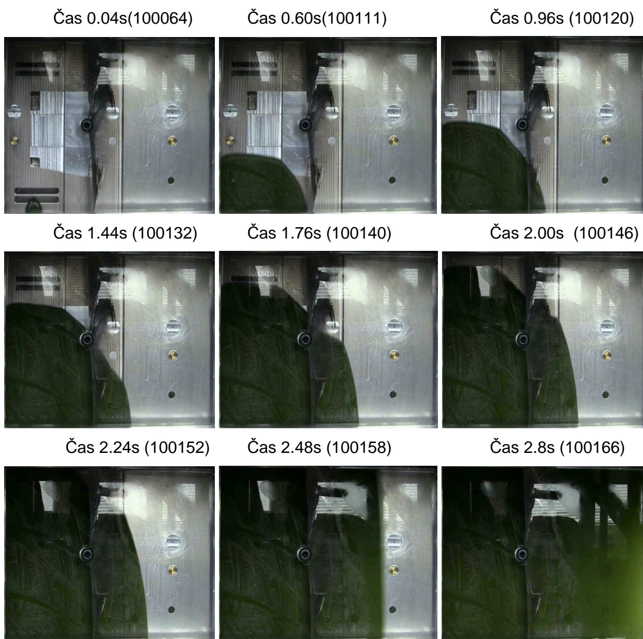
Obr. P2.10 Průběh zaplňování dutiny testovací formy II ve zvolených časových okamžicích při nastavení 2IIC15a. Nastavení vstřikovacích parametrů: Flow 300dílků a Pressure 150dílků. Čísla v závorce mají informativní účel a udávají číslo framu ze záznamu.
