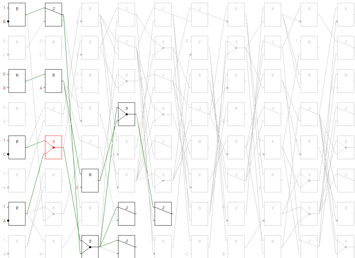
Obrázek B.7: Příklad konfigurace hradla NAND-3
