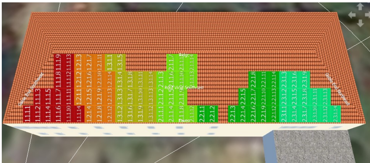
Obrázek 29 – Rozdělení panelů do stringů
