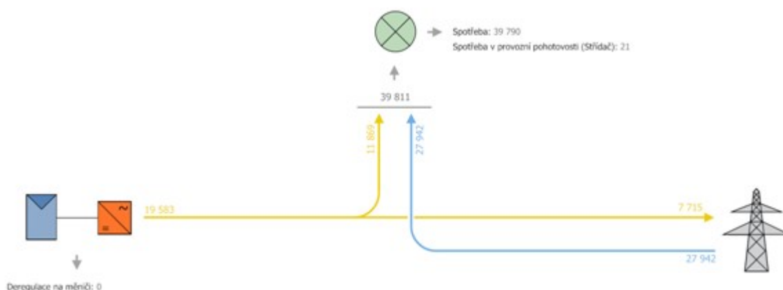
Obrázek 41 – Tok energie FVE s hodnotami panelů námi naměřenými
