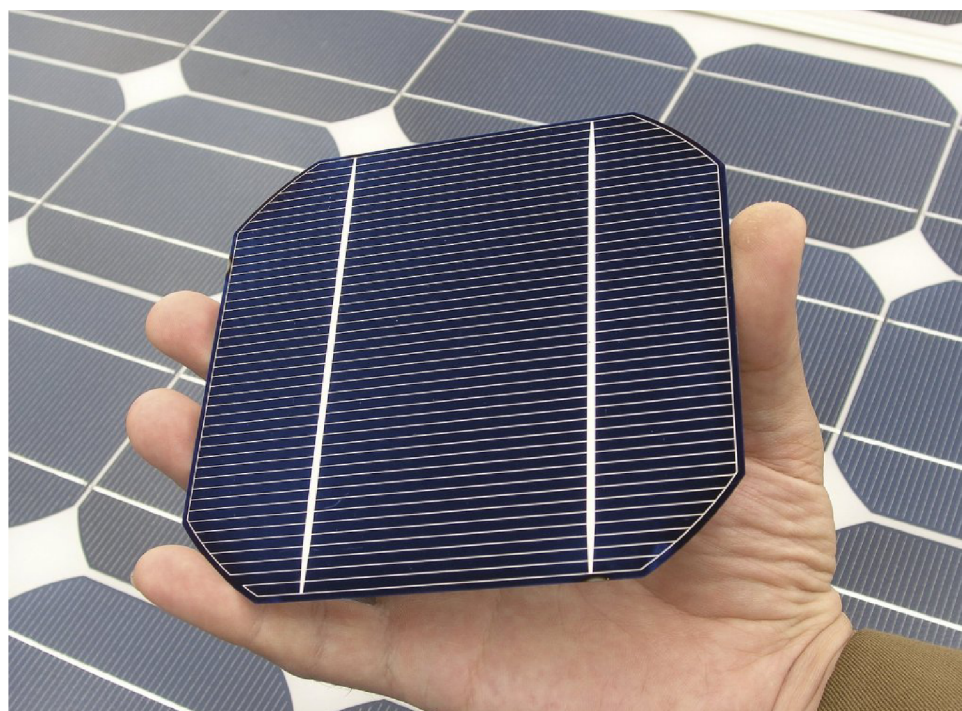
Obrázek 8- Standardní polovodičový FV článek na bázi monokrystalického křemíku [7]
