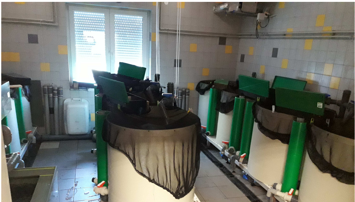
Obr.4. Odchovné nádrže využívané při adaptaci rychleného plůdku okounka pstruhového ( Micropterus salmoides ) na podmínky RAS a peletované krmivo.
