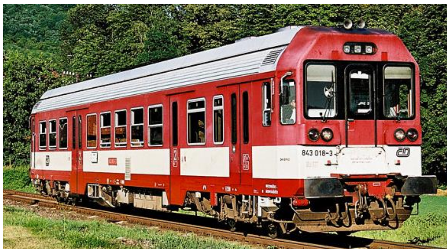
Obr. 12 Motorový vozeň 843 s elektrickým prenosom výkonu [35]
