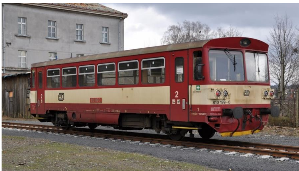
Obr. 22 Motorový vozeň 810 s hydromechanickou prevodovkou Praga 2 M 70 [28]
