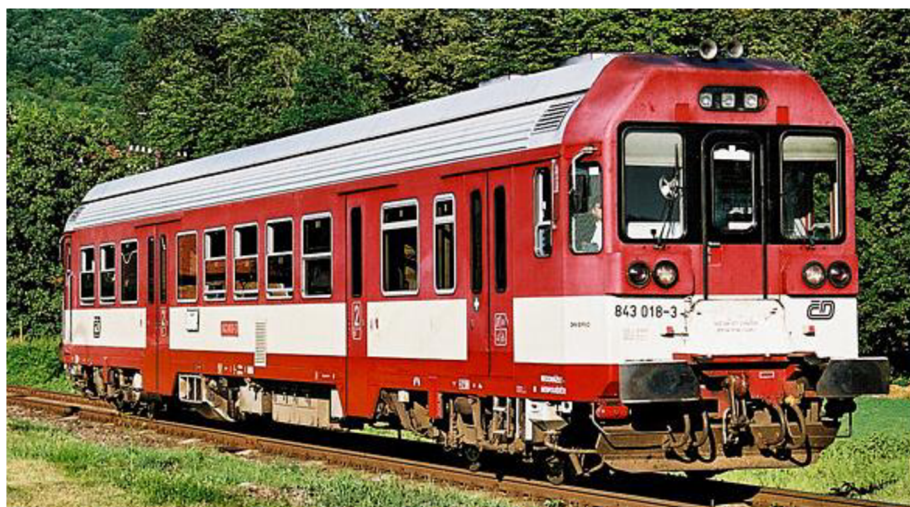
Obr. 12 Motorový vozeň 843 s elektrickým prenosom výkonu [35]
