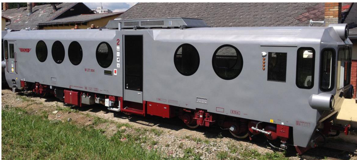
Obr. 27 Zrekonštruovaný motorový vozeň M27 s hydrostatickým prenosom výkonu [30]
