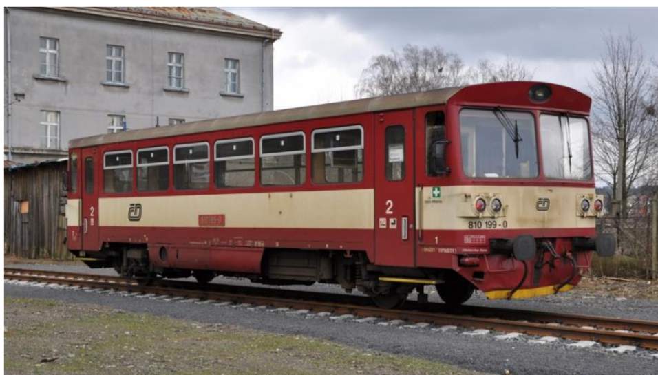
Obr. 22 Motorový vozeň 810 s hydromechanickou prevodovkou Praga 2 M 70 [28]
