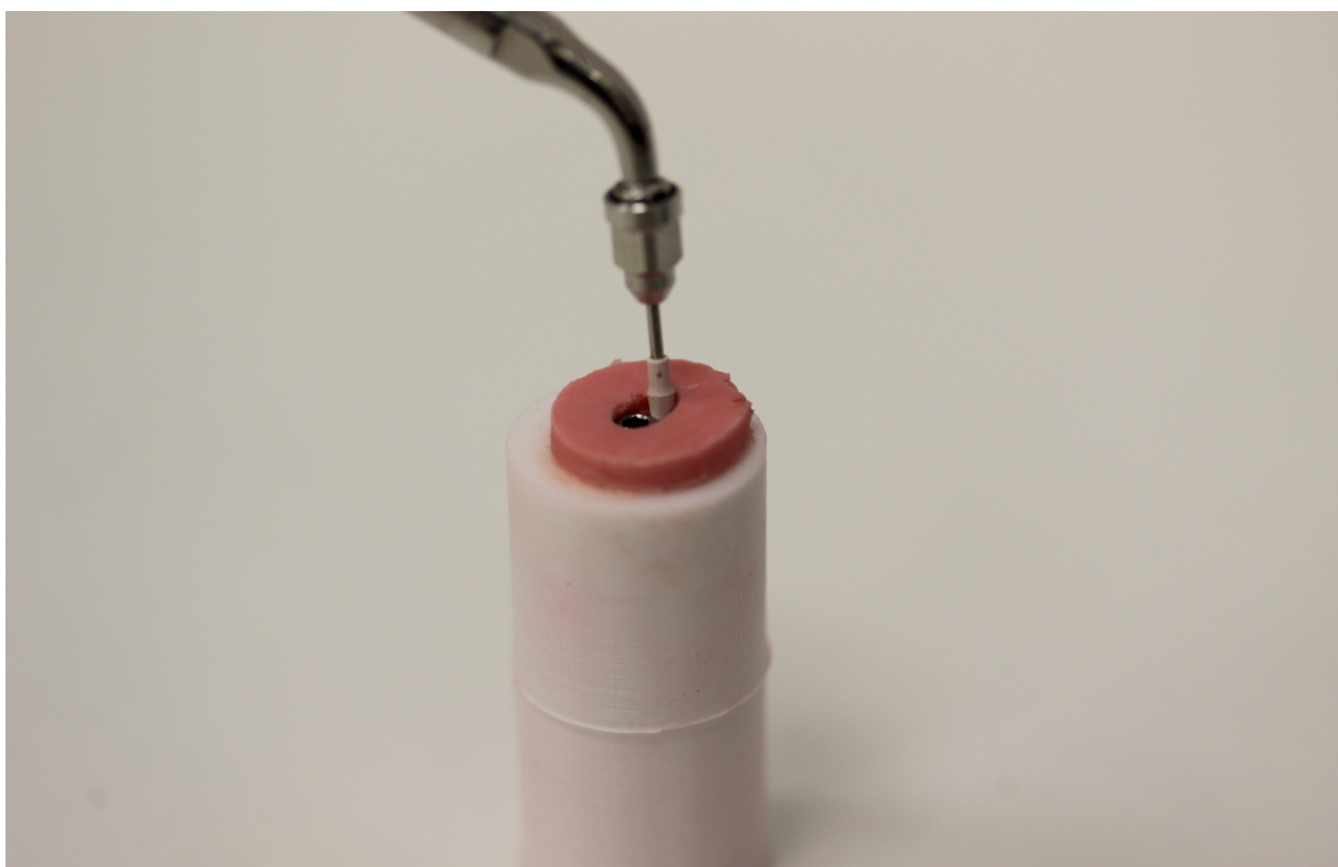
Obr. 15 - Polyetherketónová ultrazvuková koncovka pri čistení povrchu DI
