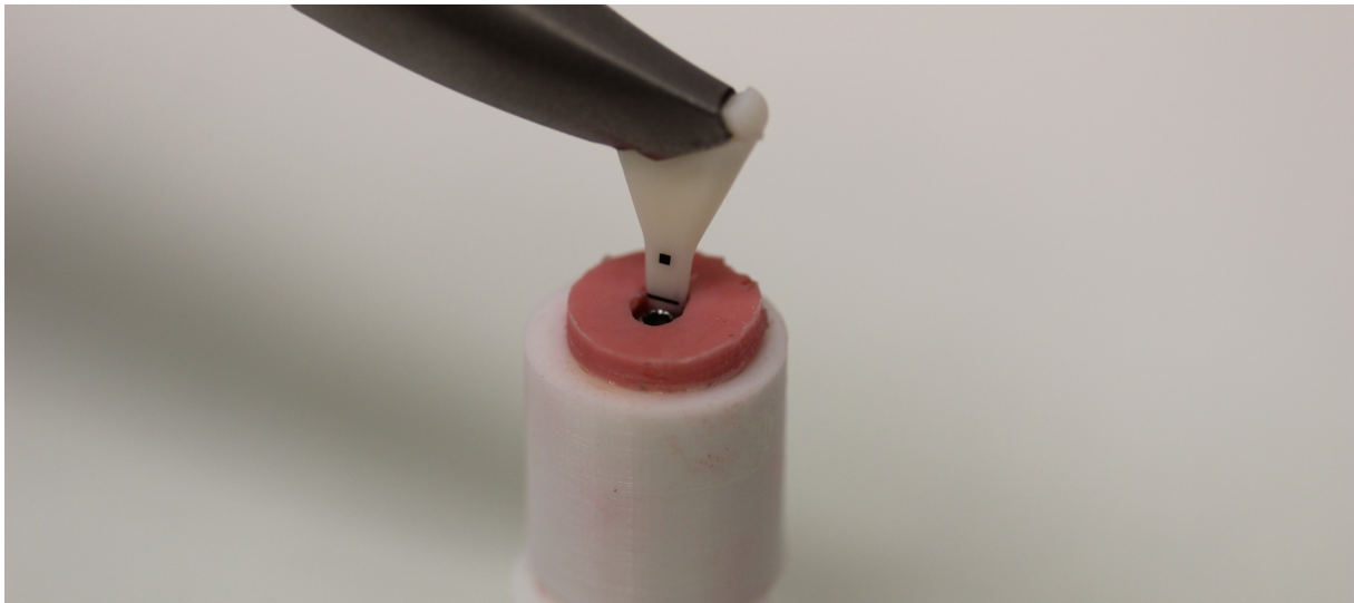
Obr. 16 – Mikroabrazívny pieskovač pri čistení povrchu DI
