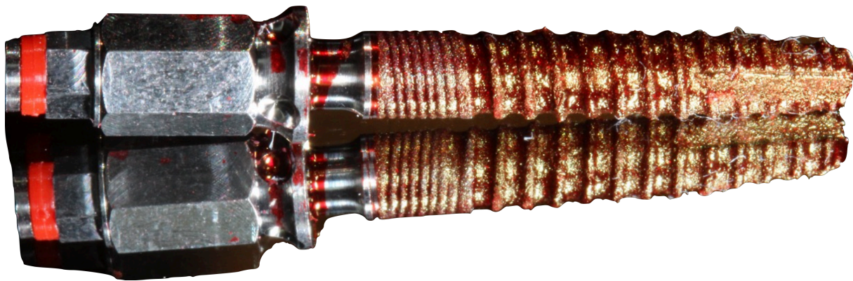
Obr. 12 – Zavedenie dentálneho implantátu do modelu zhotoveného na 3D tlačiarňi
