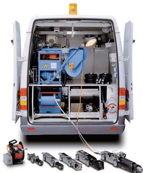
Obr. 4 - Mobilní pracoviště pro inspekce stokových sítí pomocí TV kamery. Zdroj: Zepri 2009
