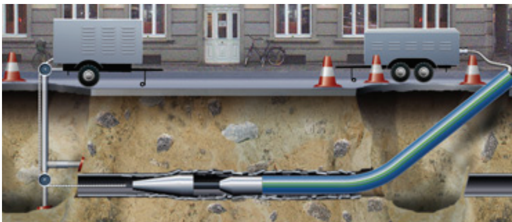
Obr. 21 - Dynamické trhání starého potrubí. Zdroj: Gerex 2007
