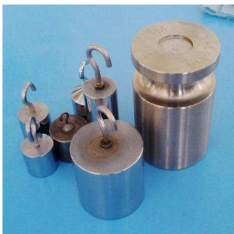
Obrázek 25: Závaží používaná při měření tloušťky na tloušťkoměru Mesdan
