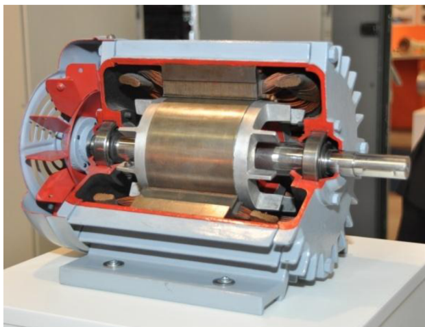
Obrázek 3 Řez Asynchronním motorem [1]
