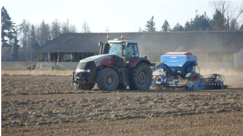
Obr. 26: Setí ječmene jarního sečí kombinací Lemken Solitair 9 a traktorem Case Magnum 340 (vlastní fotodokumentace)
