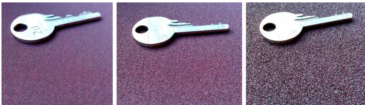
Obr. 41 – Zrnitost brusných pláten; zleva: P240, P120 a P60 (klíč použit jako měřítko)
