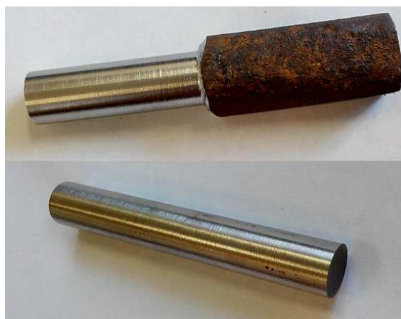
Obr. 36 – Nahoře: Z poloviny opracovaný vzorek na váleček, dole: zcela opracovaný vzorek
