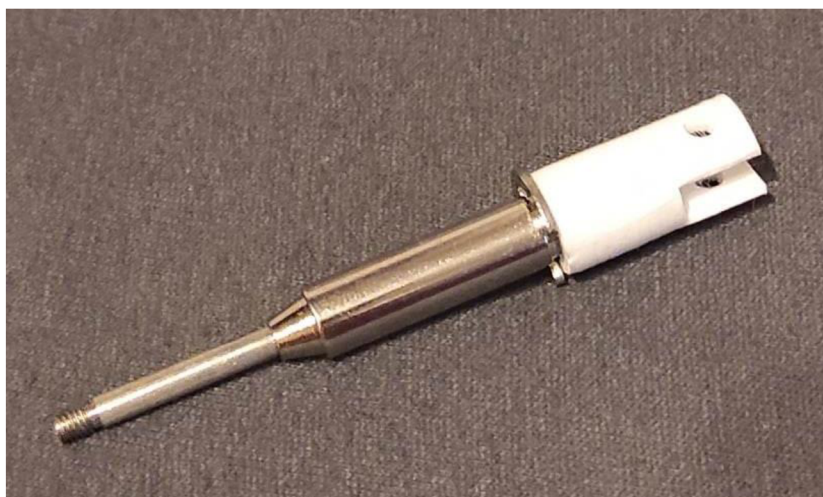
Obrázek 13 - Plastová vidlice nalisovaná na plunžrové jádro
