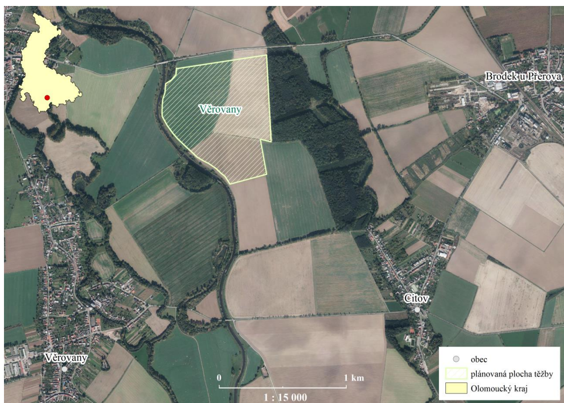
Obr. 10 Rozsah plánované těžby na ložisku Věrovany pro rok 2012 (zdroj: ARCDATA PRAHA, 2014; ŽÍDKOVÁ, 2009; vlastní zpracování)
