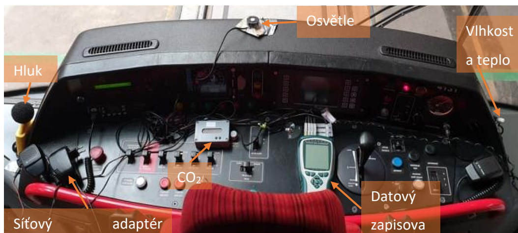
Obrázek 6: Rozložení měřicí aparatury v kabině
