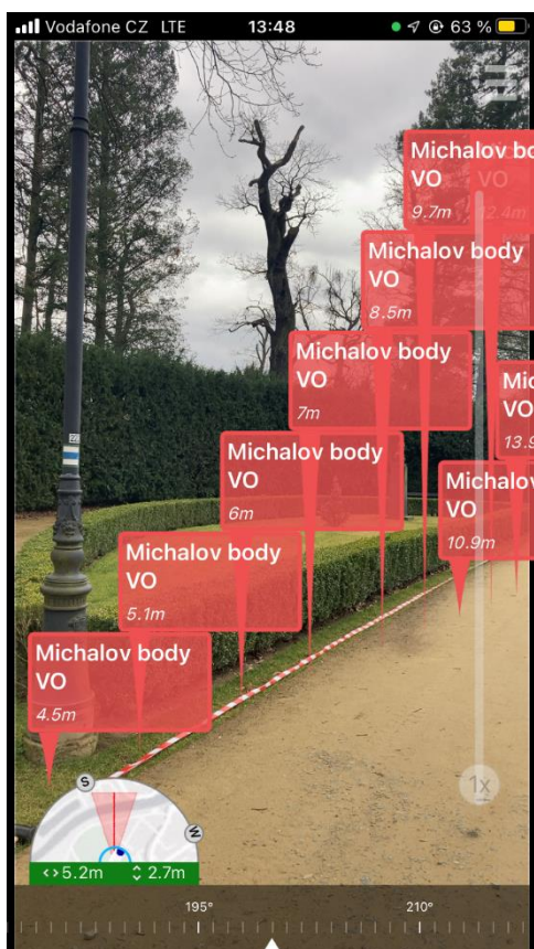
Obr. 9: Michalov kabely veřejného osvětlení
