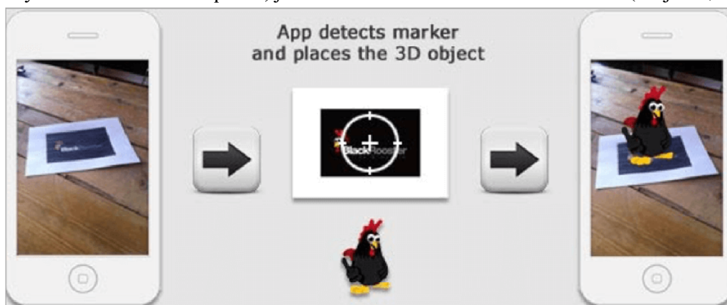
Obr. 4: Ukázka principu marker-based AR
