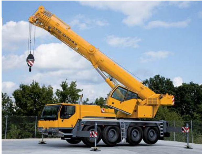
Obrázek 6-13 Autojeřáb Liebherr LTM 1070 [19]
