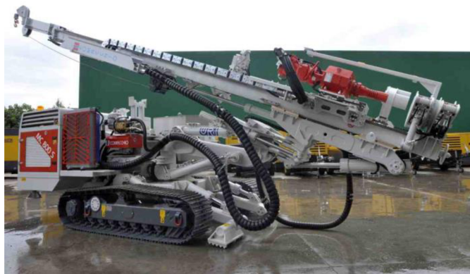
Obrázek 6-8Vrtná a napínací souprava [14]
