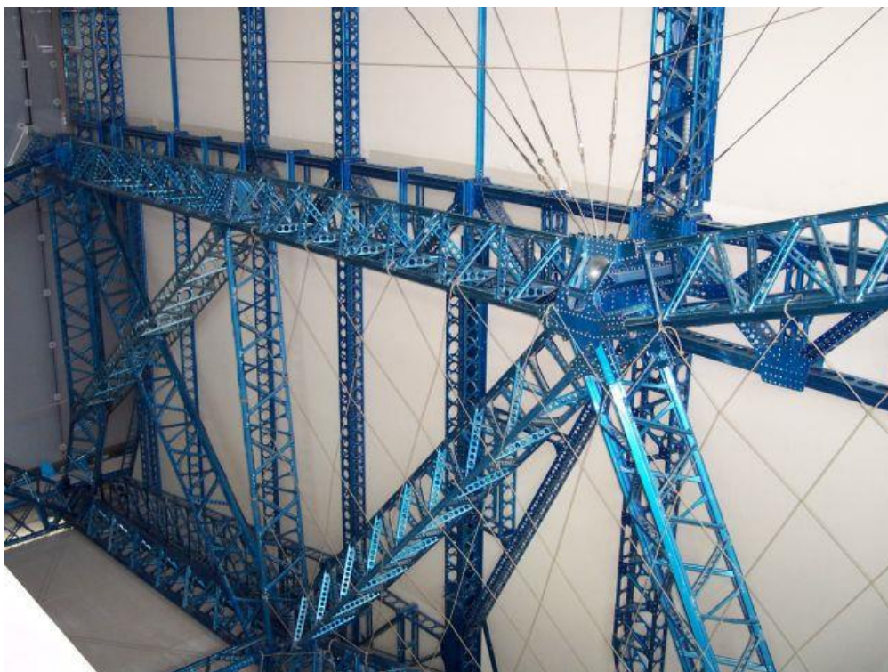
Obr. 3-14 Nýtovaná konstrukce kostry z trojúhelníkových duralových nosníků [27]
