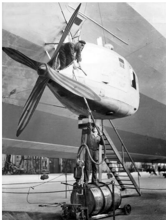
Obr. 3-3 Motorová gondola LZ 127 při doplňování oleje [23]
