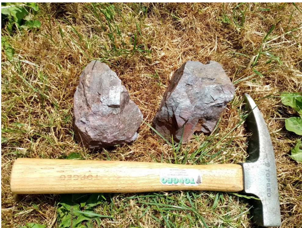
Obr. 15: Křemen-hematitové (jaspilitové) rudy s magnetitem z lokality Ponikev 2 (foto Kvaltinová, 2022).
