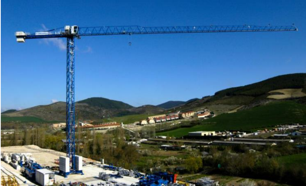
Obrázok 33: Comnasa 11LC90 so zdvihom bremena 36m a vyloženie 50m/1,4t [12]
