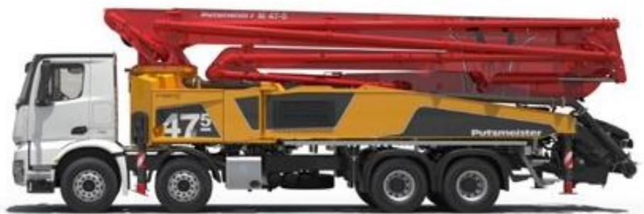
Obrázok 39: Autočerpadlo betónovej zmesi [13]
