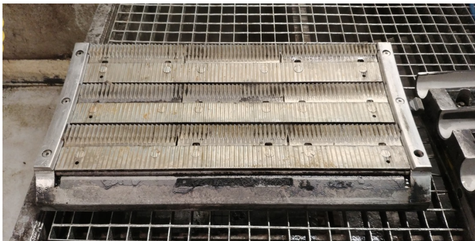
Obr. 20 Nožová hlava osazená upínacími deskami v provozu
