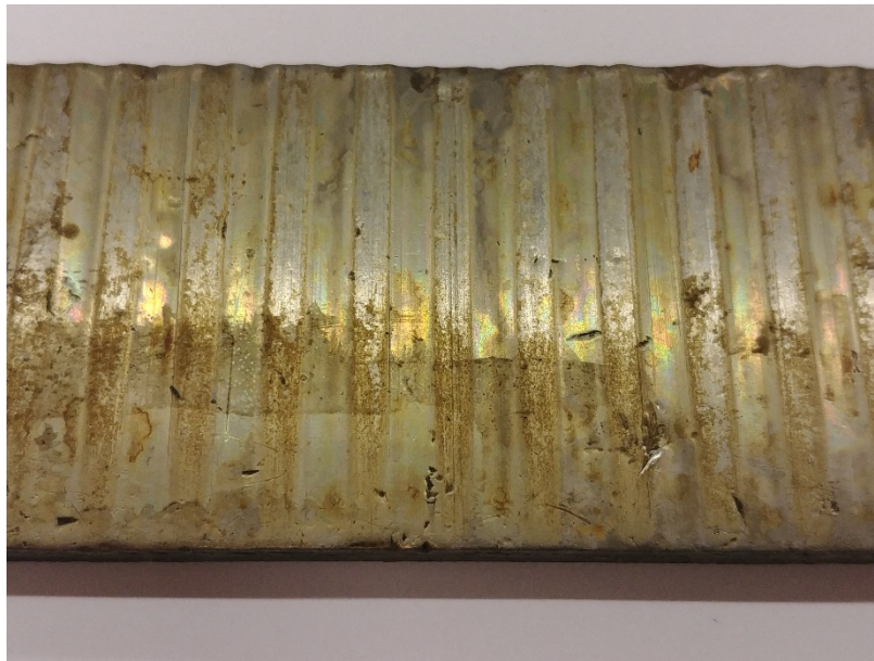
Obr. 1 Drážky na povrchu upínací desky Putsch bez povlaku
