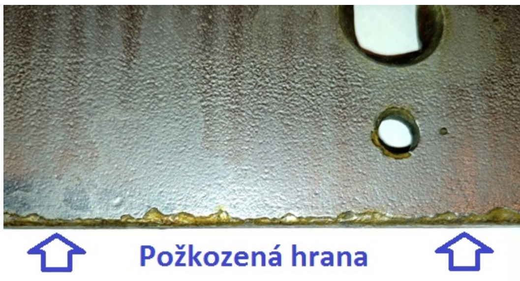
Obr. 32 Deformace hrany upínací desky značky Putsch s povlakem
