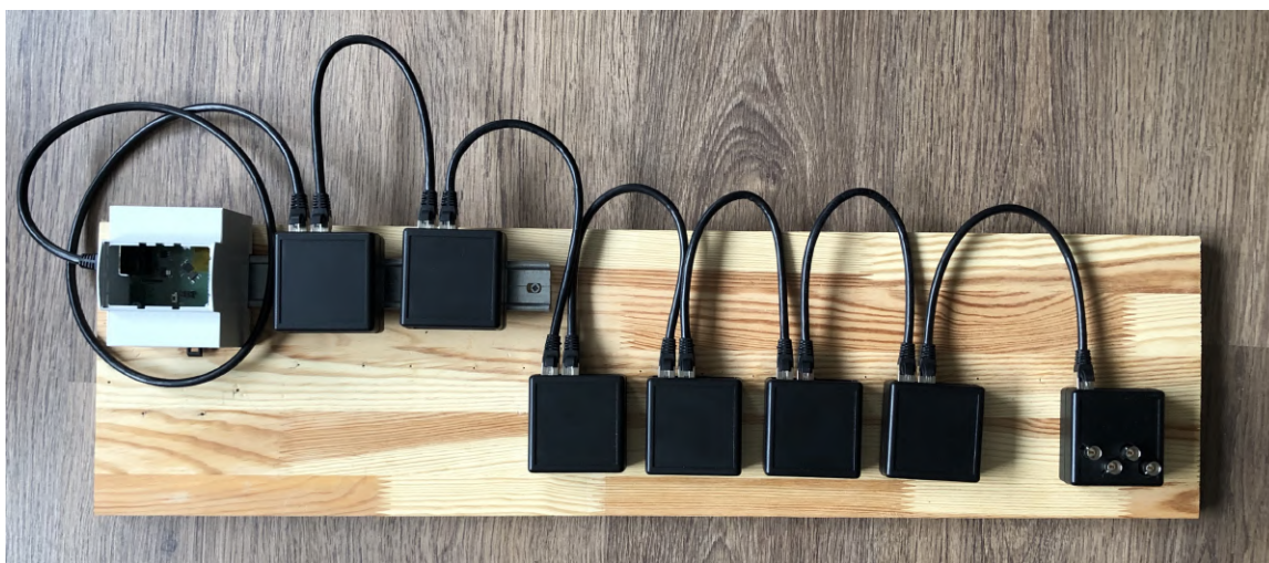
Obrázek 6.8: Sestavený řídicí systém. Na snímcích jsou otevřené a zavřené krabičky s moduly. Jejich pořadí je zleva: Raspberry Pi s CAN převodníkem, vstřikování enzymu, regulace teploty, řízení míchání a modul regulace pH.
