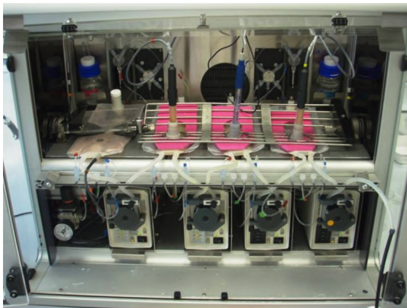
Obrázek 2.2: První verze disolučního přístroje Golem
