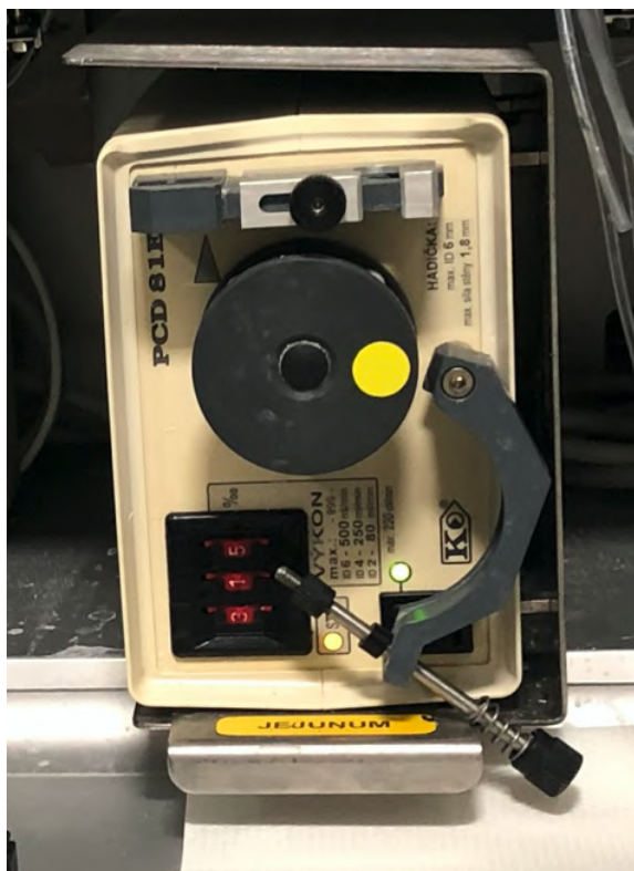
Obrázek 3.10: Peristaltická pumpa PCD 81E. Červeným přepínačem je možné nastavit výkon pumpy.
