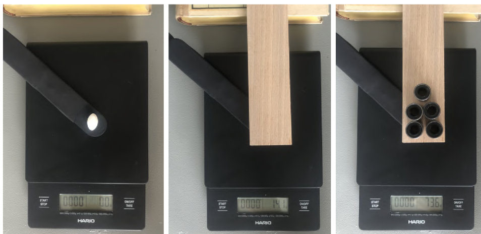
Obrázek 8.2: Postup kalibrace senzoru síly na tabletu. Na prvním obrázku je na sensor umístěna pouze tableta, poté dřevěná laťka a na ni postupně přidáváno závaží.
