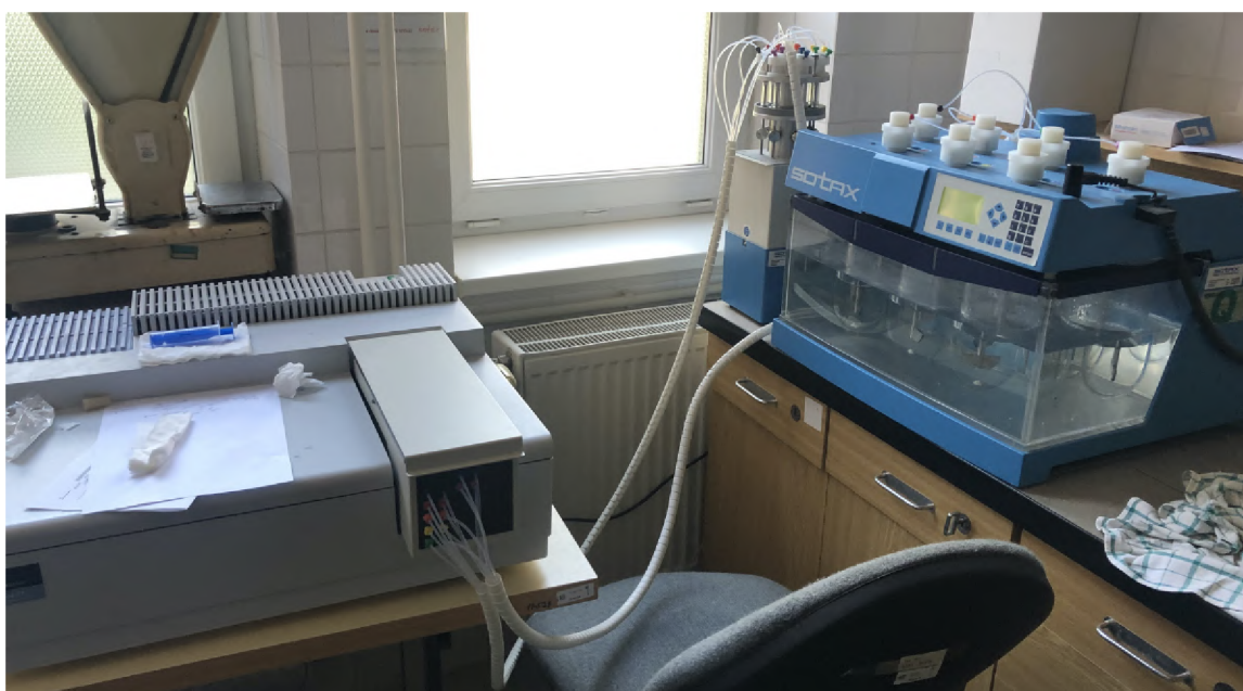
Obrázek 2.1: Disoluční zařízení Sotax AT7. Do skleněných kopulí s vhodným roztokem, umístěných v nádobě s vodou s konstantní teplotou, je vložena zkoumaná léková forma, která se za stálého míchání rozpouští. Připojená pumpa periodicky odebírá vzorky z nádob a předává je k analýze na spektrometru, čímž je možné zjistit časový průběh uvolňování jednotlivých látek.
