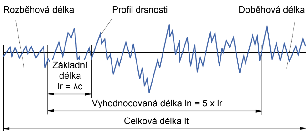
Obr. 4.4 Základní a vyhodnocovaná délka, délka rozběhu a doběhu (36)
