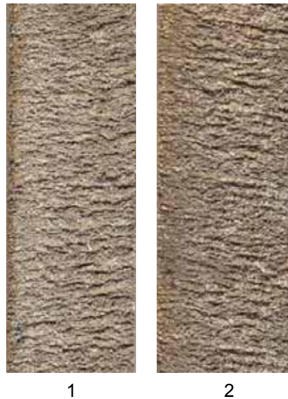
Obr. 5.11 Detail řezných ploch zkušebních vzorků vytvořených laserem
