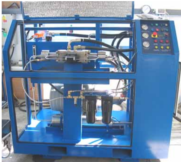
Obr. 5.2 Vysokotlaké čerpadlo PTV-37-60 Pump (bez krytáže)
