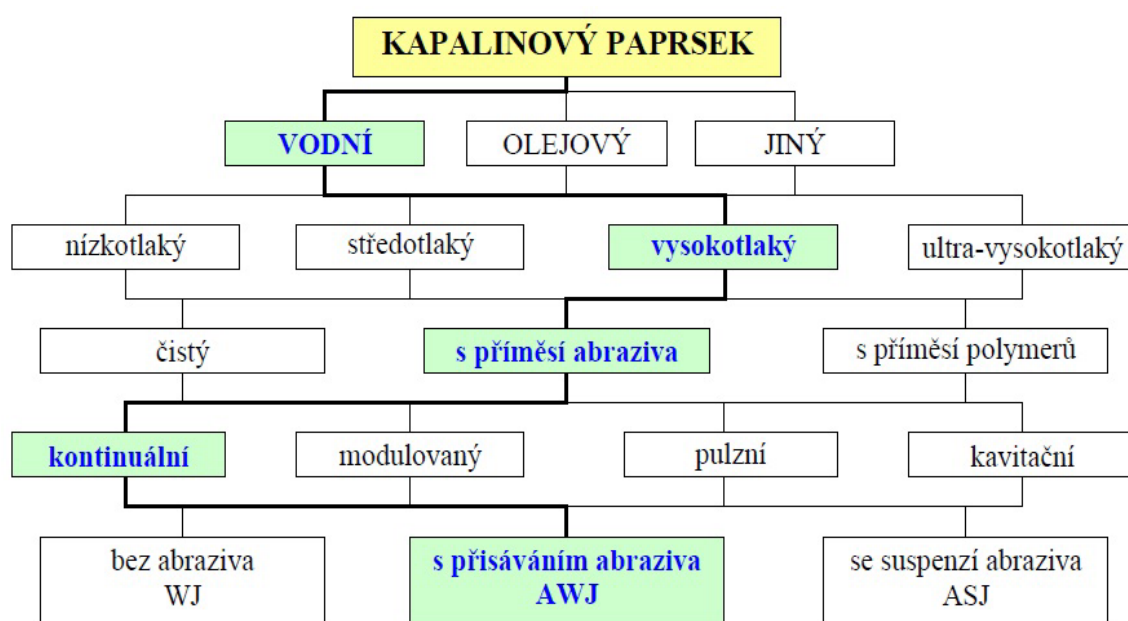
Obr. 2.1 Rozdělení kapalinových paprsků (6)
