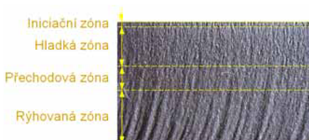
Obr. 3.14 Povrch vytvořený hydroabrazivním paprskem s vyznačením iniciační, hladké, přechodové a rýhované zóny
