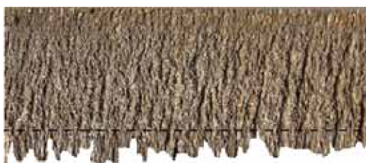
Obr. 5.32 Výronek na spodní straně řezné hrany u vzorku č. 2 řezaného laserem
