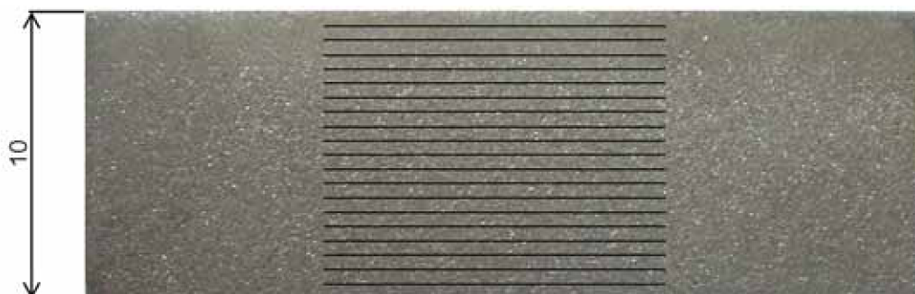
Obr. 5.13 Fotografie povrchu vzorku č. 1 vytvořeným na zařízení AWJ s vyznačením 19-ti měřicích linií s krokem 0,5 mm
