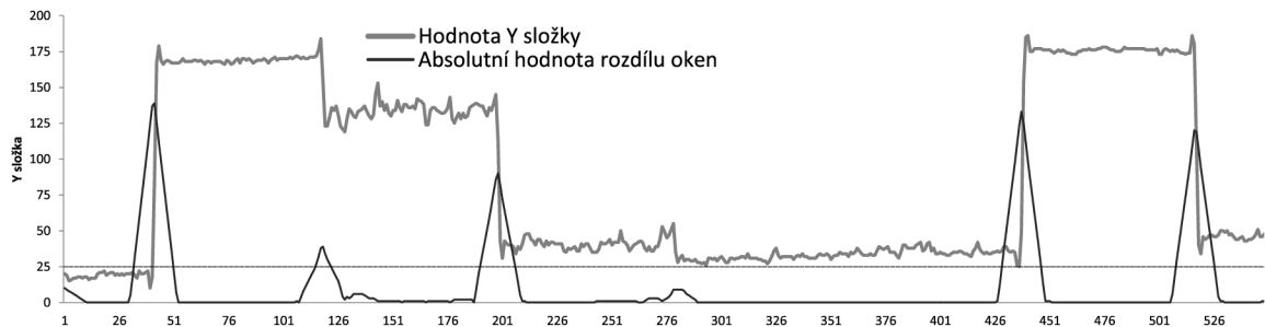
Obrázek 4.1: Hledání hran pomocí dvou oken plovoucího průměru.
