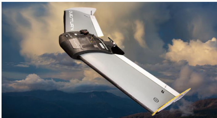
Obrázek 10: dron s pevným křídlem a tlačnou vrtulí, model Q200 od firmy QuestUAV [22]
