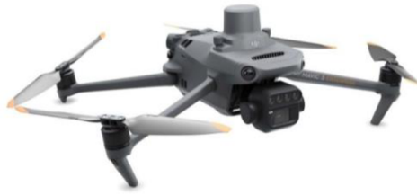
Obrázek 11: kvadrokoptéra DJI Mavic 3 Enterprise s RTK modulem a multispektrální kamerou [24]
