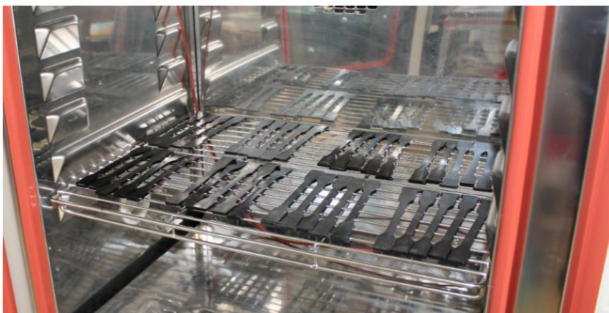
Obr. 18 Uložení zkušebních těles v klimatické komoře Votsch VC 0018
