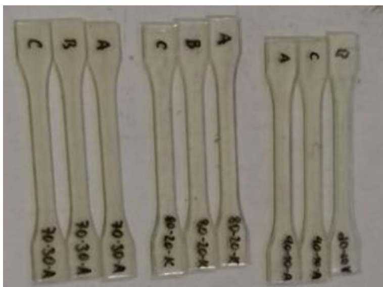
Obrázek 63. Vzorky typu "bone" pro zjištění tahových vlastností.
