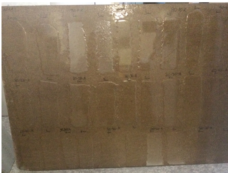
Obrázek 49. Cementotřísková deska zapenetrovaná IN-EPOX 2020 s aplikovanými vzorky testů aplikovatelnosti
