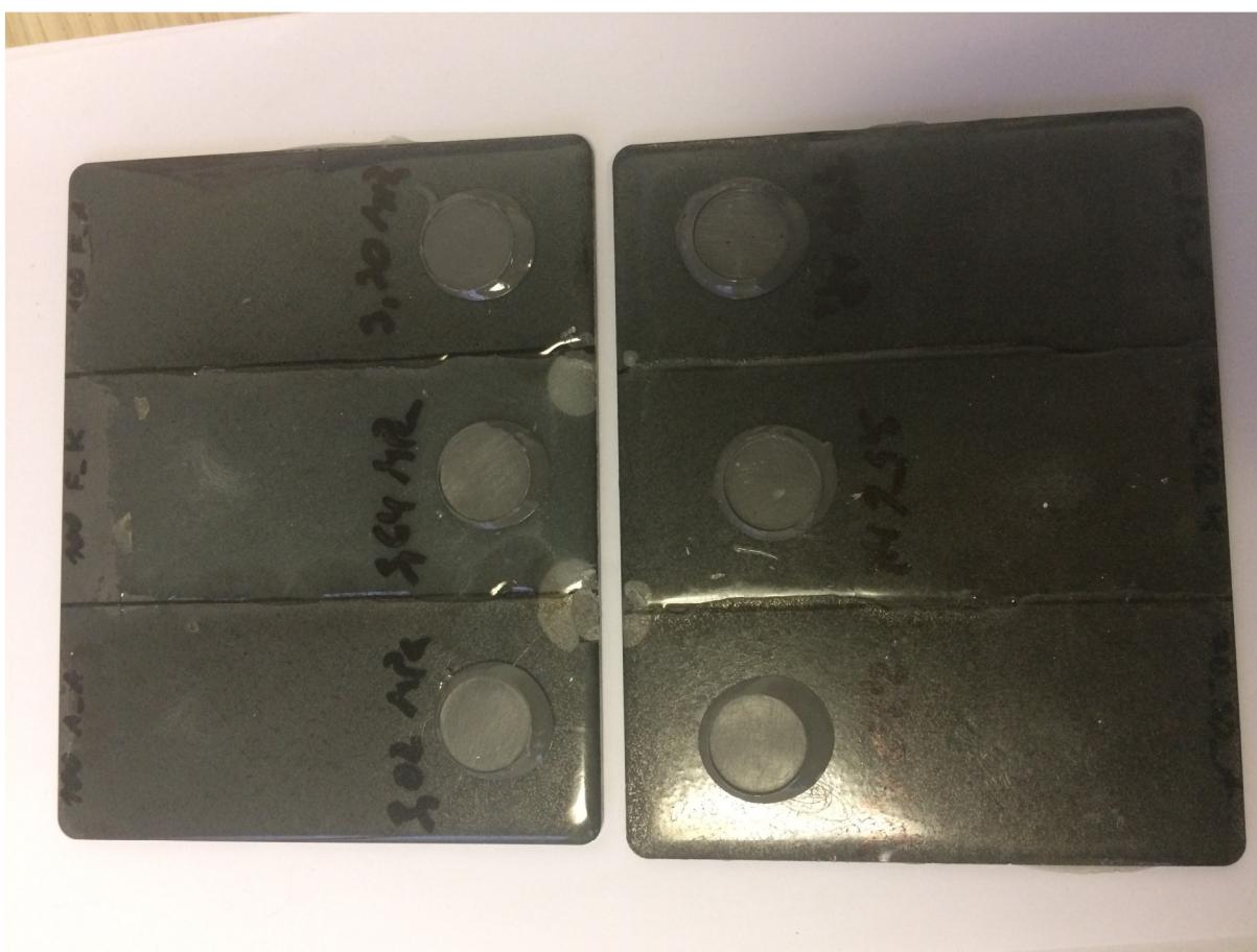
Obrázek 57. Provedené odtrhové zkoušky epoxidových nátěrových systémů na kovové destičce o tloušťce 6 mm
