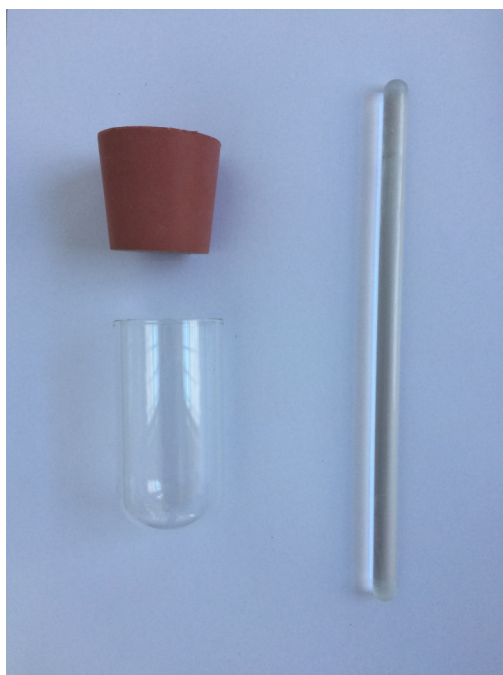
Obrázek 38. Speciální zkumavka, zátka a tyčinka pro zjišťování tendence ke krystalizaci dle ISO 4895.
