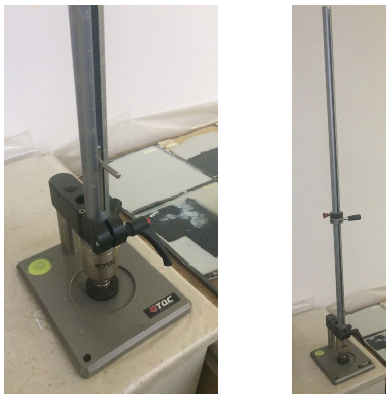
Obrázek 51. Zařízení pro zjištění odolnosti v rázu TQC SP 1890.
