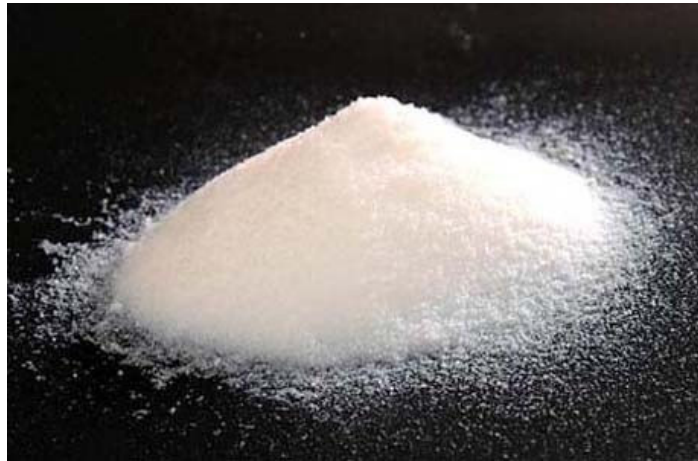
Obrázek 31. Pyrogenní silika, měrný povrch 200 m 2 /g.
