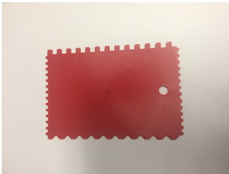
Obrázek 48. Stěrka o velikosti zubu 3 mm (levá strana) a 6 mm (horní strana)
