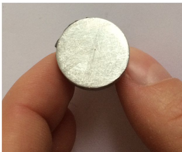
Obrázek 55. Odtrhová panenka o průměru 20 mm.
