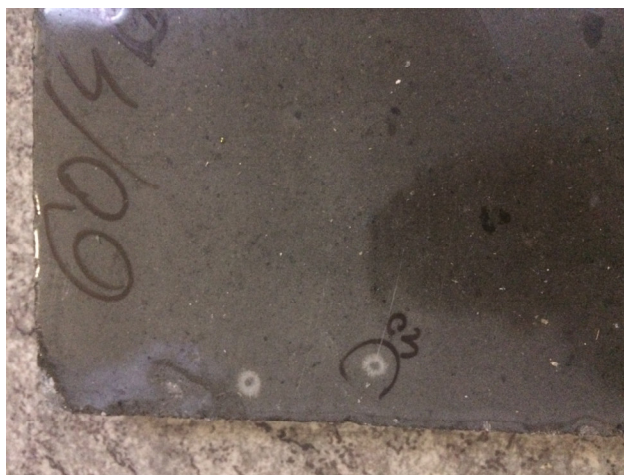
Obrázek 51. Provedený test odolnosti v rázu spuštěním úderníku z 40 cm na vzorek č. 4 z Tabulky 32.
