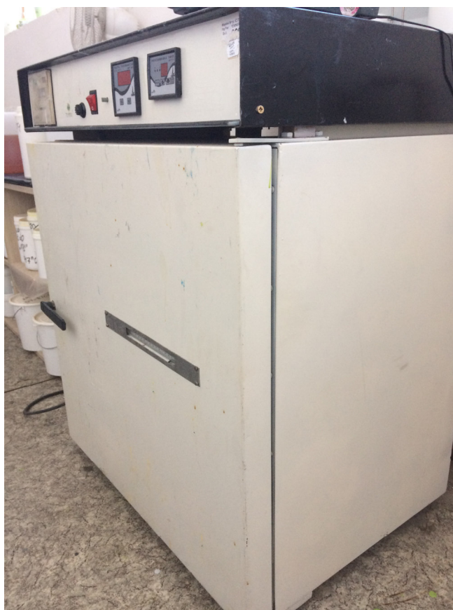
Obrázek 39. Termokomora použitá při zjišťování tendence ke krystalizaci dle ISO 4895.
