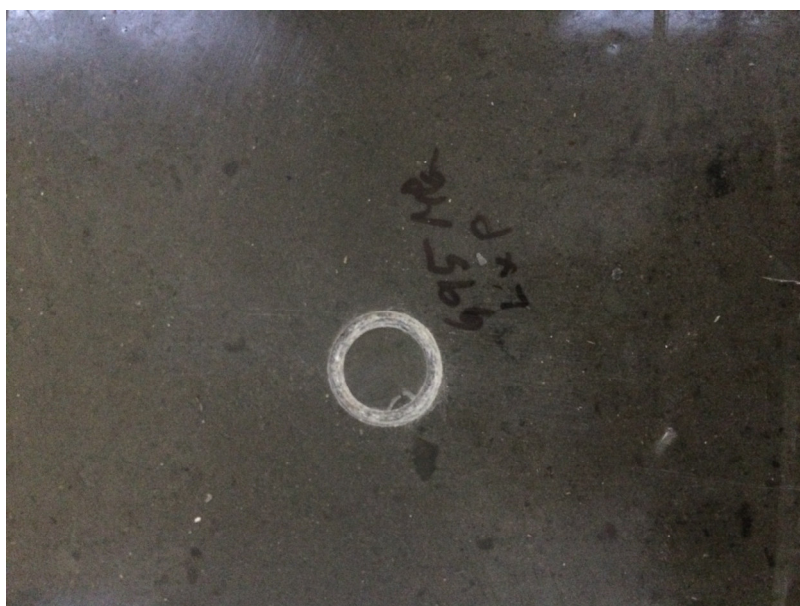
Obrázek 56. Vykrúžovadlem vykroužený vzorek vytvrzeného epoxidové nátěru na vibrované betonové desce
