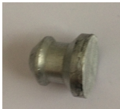
Obrázek 55. Odtrhová panenka o průměru 20 mm.
