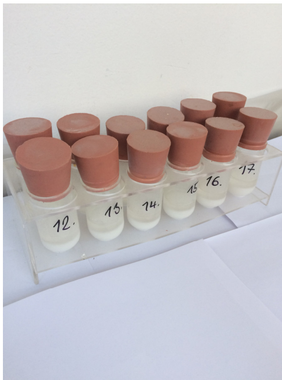
Obrázek 40. Sada vzorků zjišťování tendence ke krystalizaci dle ISO 4895.
