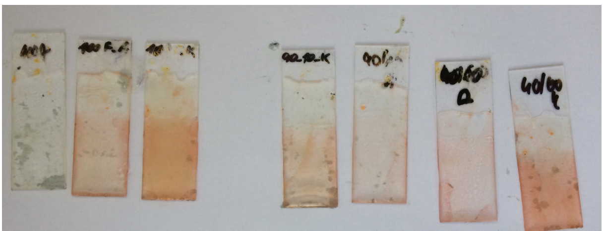
Obrázek 83. Vzorky ponořené v 50% vodném roztoku H 2 SO 4 4 týdny.
