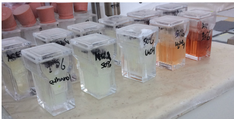
Obrázek 85. Kyvety se vzorky ponořeny do chemikálií 4 týdny.
