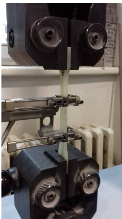
Obrázek 64. Vzorek typu "bone" upnutý v čelistech zařízení pro měření tahových vlastností.
