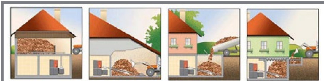
Obr. 2-11 Schéma možností přívodu paliva šnekovým dopravníkem [13]
