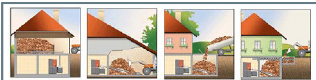
Obr. 2-11 Schéma možností přívodu paliva šnekovým dopravníkem [13]
