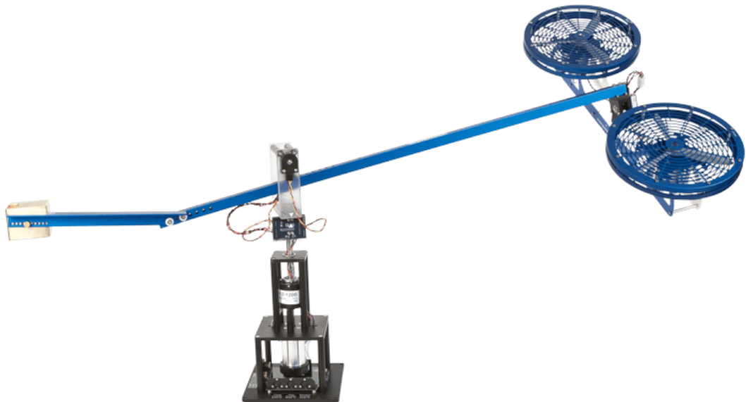
Obrázek 4 - Přípravek 3DOF helikoptéry od firmy Quanser [12]
